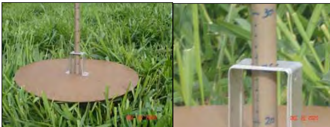
Figura 4 - Prato ascendente utilizado na coleta de amostras.
