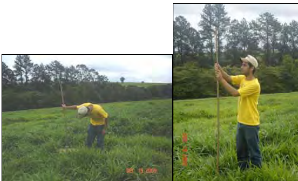
Figura 6 - Medições de altura com prato ascendente e com bengala.
