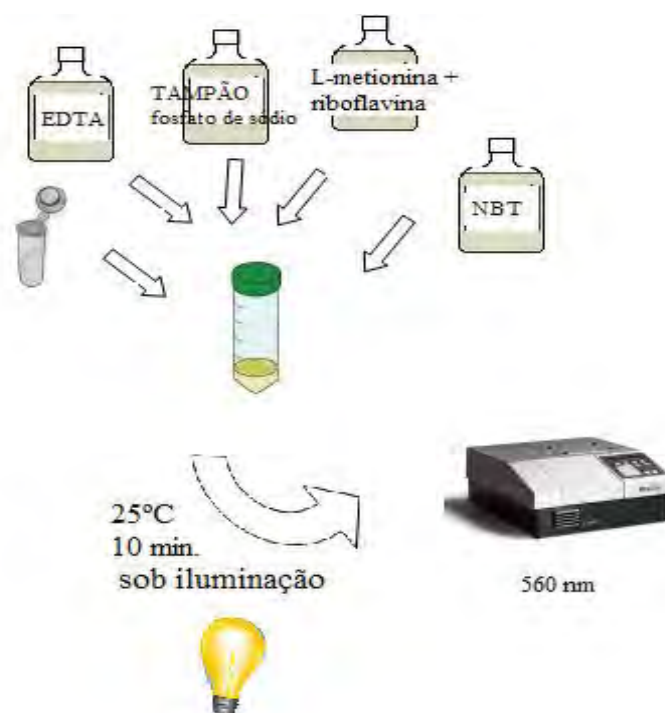
Figura 12. Esquema da técnica da determinação da atividade da superóxido dismutase.
