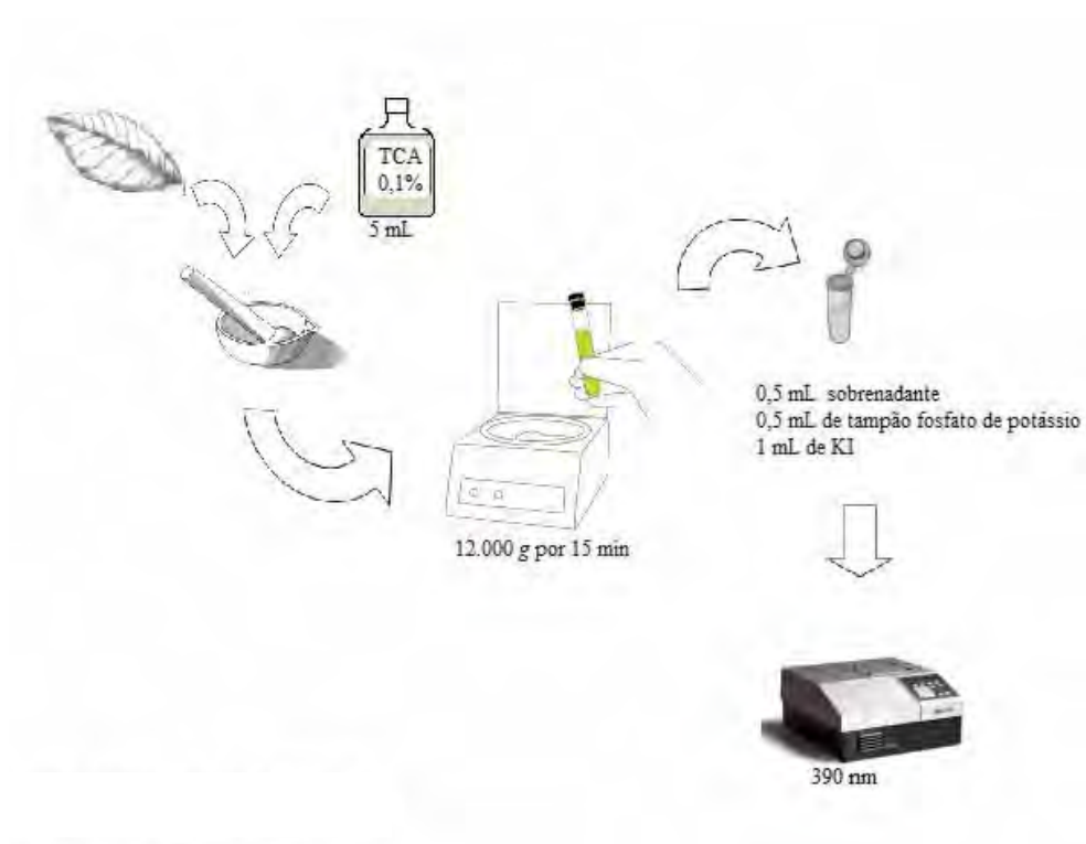
Figura 9. Esquema da técnica da determinação do conteúdo de peróxido de hidrogênio.
