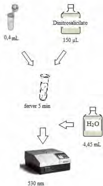
Figura 6 . Esquema da técnica da determinação do conteúdo açúcares solúveis redutores.
