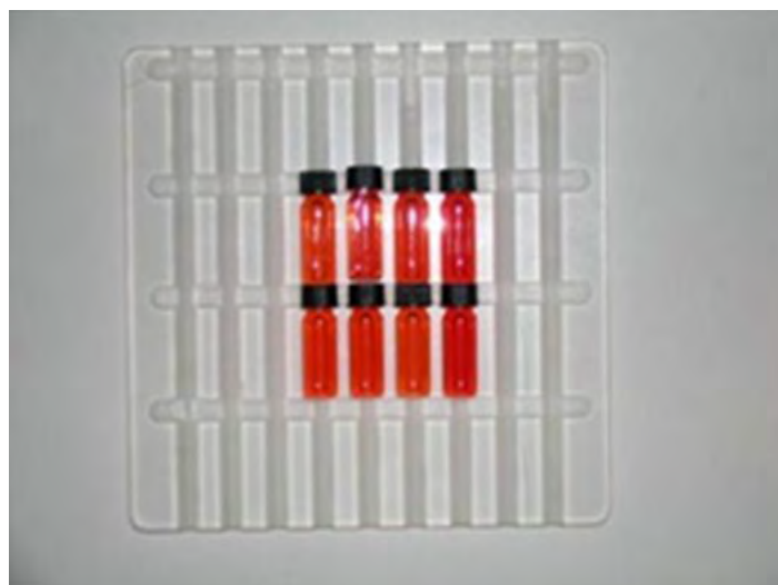
Figura 3. 6 – Amostras acondicionadas em porta amostras de PMMA para irradiação na unidade de cobaltoterapia.
