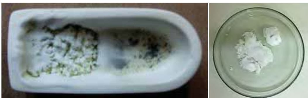
Figura 4.1 – Material aderido à barquinha e coletado na extremidade do forno resultante da síntese pelo método de redução carbotérmica.
