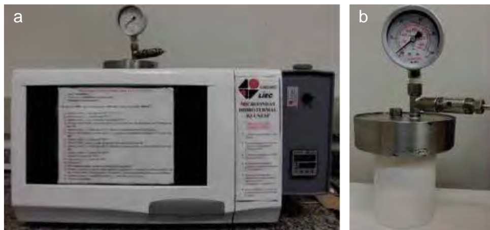
Figura 3.2 – Micro-ondas adaptado e célula reacional com controle de pressão.
