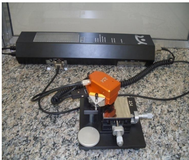
Figura 2.11: Aparelho de medidas de AFM Nanosurf easyScan 2 Controller.
