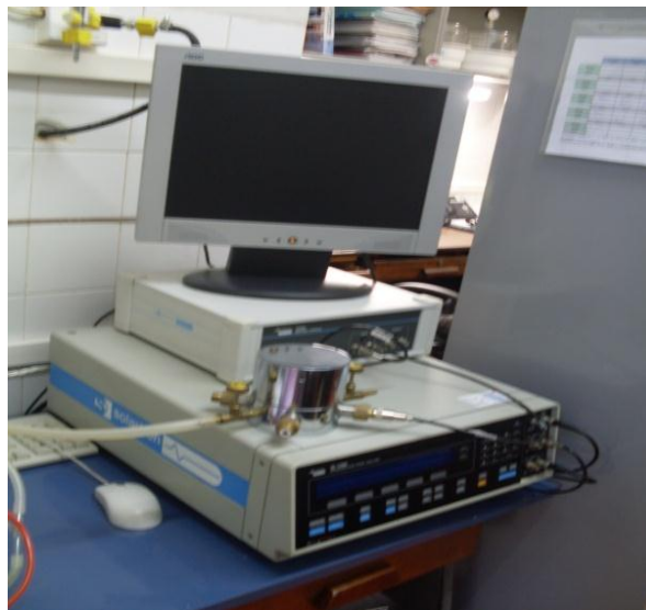
Figura 2.8: Fotografia do medidor de impedância 1260 da Solartron com o criostato e o monitor do micro computador de controle.
