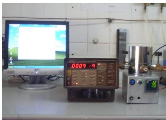
Figura 2.10: Montagem experimental para realizar as medidas de corrente elétrica.
