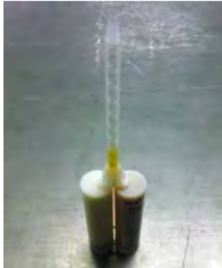
Figura 37: Cartuchos, contendo os componentes do adesivo, acoplados a um misturador estático.
