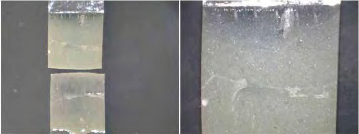
Figura 71: Modo de falha do tipo coesivo, encontrado nos corpos de prova do grupo 3 ensaiado em clivagem.
