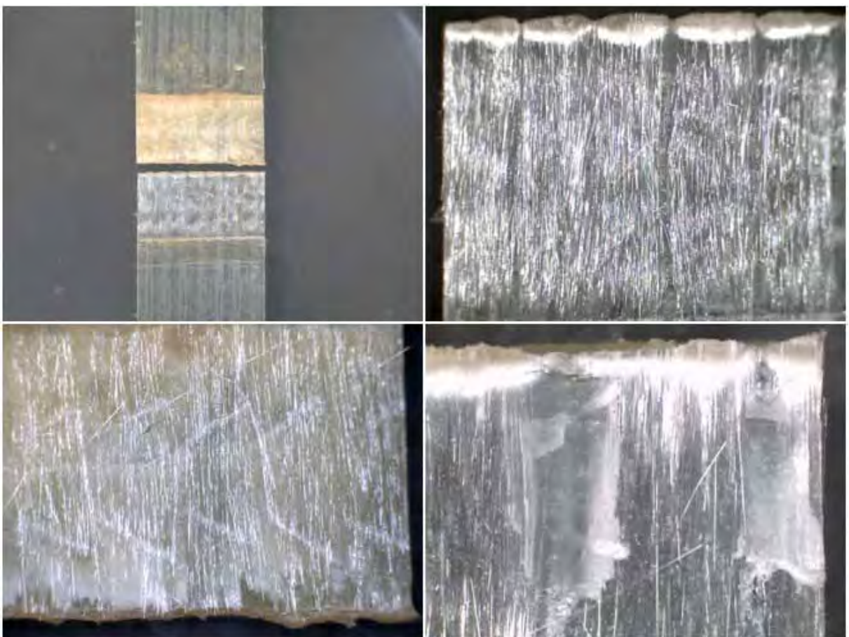
Figura 86: Modo de falha misto (90% rompimento de fibra e 10% adesiva), encontrado nos corpos de prova do grupo 7 ensaiado em cisalhamento.
