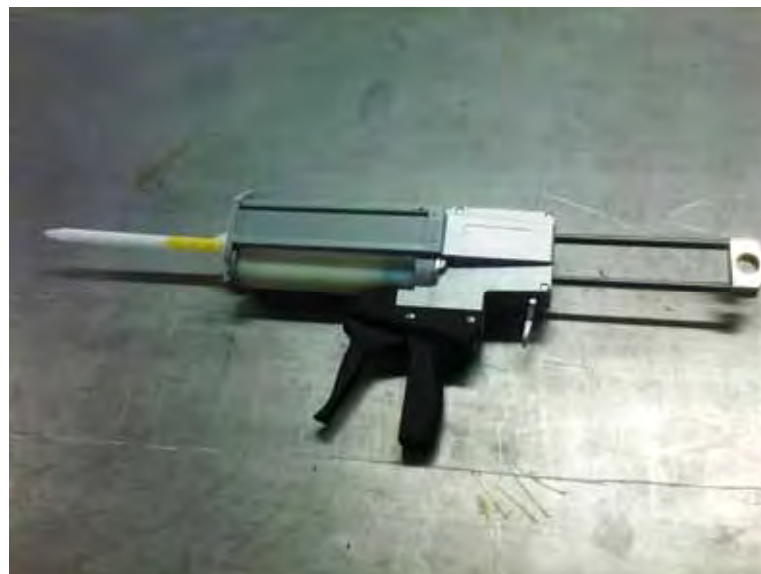
Figura 38: Pistola aplicadora carregada com os cartuchos.
