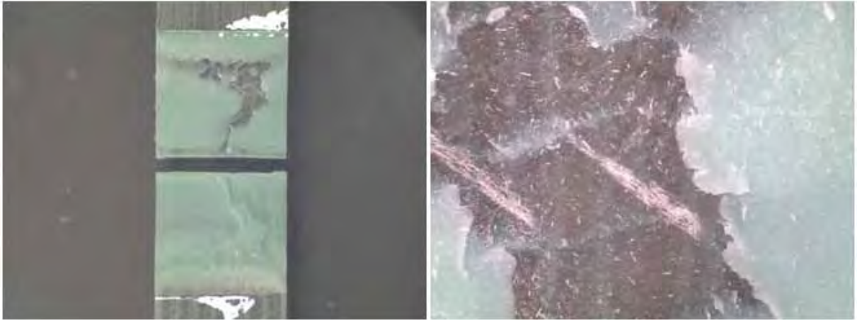
Figura 76: Modo de falha misto (20% adesivo e 80% coesivo), encontrado nos corpos de prova do grupo 4 ensaiado em clivagem.
