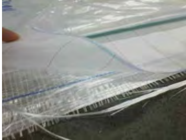
Figura 32: Aplicação da camada de nylon sobre o tecido de fibra de vidro.
