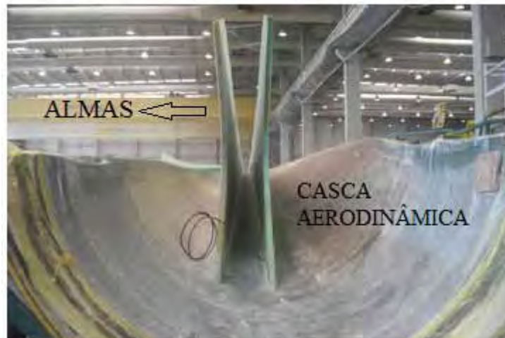
Figura 14: Almas coladas à casca aerodinâmica. (Tecsis)
