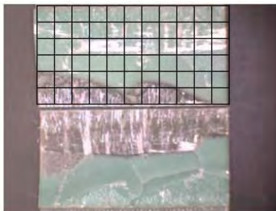
Figura 57: Modo de falha misto ocorrido nos corpos de prova do grupo 11. A grade é utilizada para calcular a proporção dos modos de falha.
