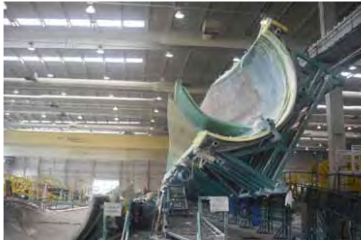
Figura 15: Molde se fechando para colagem das cascas. (Tecsis)
