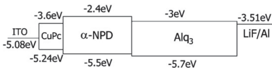
Figura 2.1-11: Estrutura e níveis de energia do OLED à base da molécula de Alq 3 [2].
