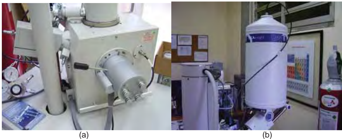
Figura 14: Fotografias da (a) câmara e (b) do reservatório de LN2 do microscópio ME Quanta Inspect S – FEI, pertencente a empresa Schaeffler Brasil Ltda – Divisão INA.
