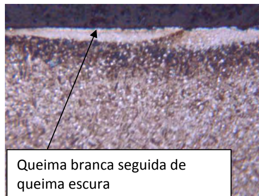
Figura 14 - Queimas de retificação (aço ABNT 52100 apresentando queimas após a retificação com abrasivo convencional (1000x)).
