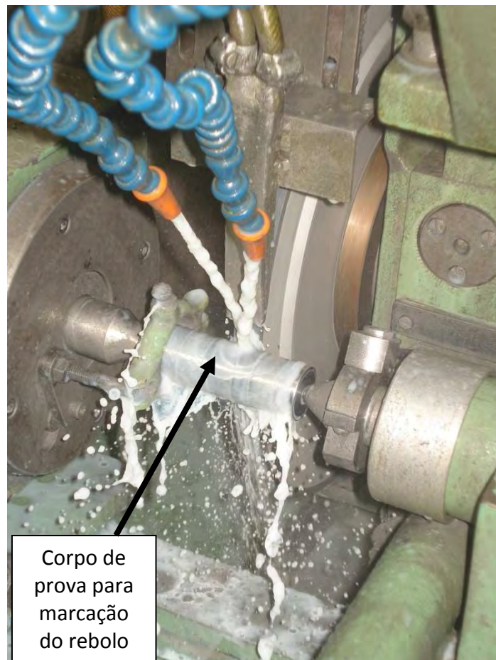
Figura 25 - Processo de marcação do rebolo.
