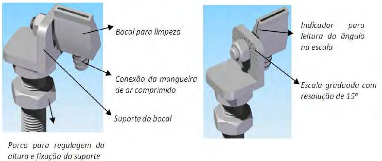
Figura 18 – Sistema de fixação e posicionamento do bocal de limpeza.
