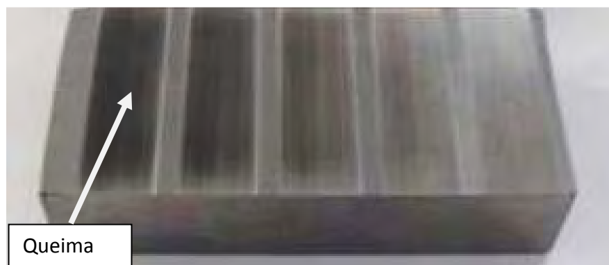
Figura 13- Queima visível de retificação (TAWAKOLI et al. 2007).
