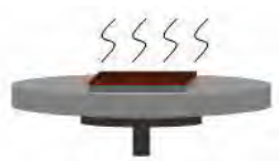
Figura 7 - Terceira etapa ( spin-coating ): evaporação do solvente contido sobre o substrato (Brewer Science, 2006)
