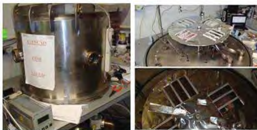
Figura 14 - Foto do equipamento de deposição por feixe de elétrons (EBE)
