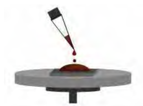
Figura 5 - Primeira etapa ( spin-coating ): Deposição de solução química sobre o substrato (Brewer Science, 2006)
