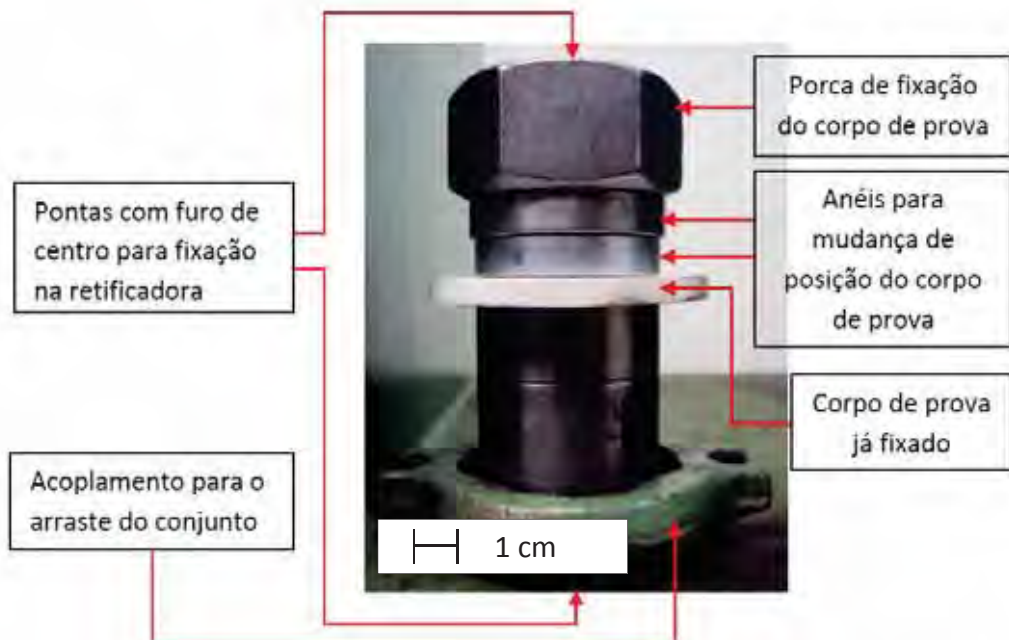
Figura 3.3. Mandril de fixação dos corpos de prova.
