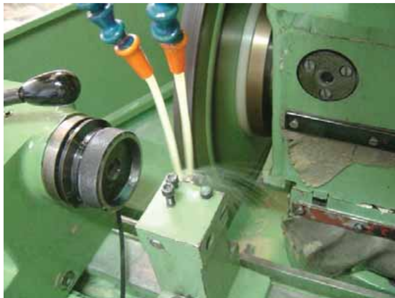
Figura 3.9. Operação de dressagem do rebolo utilizando a técnica de lubri-refrigeração convencional.
