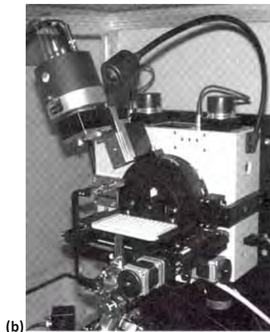
Figura 2.22. (a) Representação de um difratômetro de raios X, mostrando a amostra em forma de pó, e os feixes de raios X incidentes e difratados. (b) Fotografia de um difratômetro de raios X. (Askeland e Phulé, 2003)
