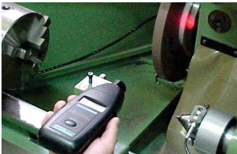
Figura 3.12. Calibração da rotação do rebolo com tacômetro digital
