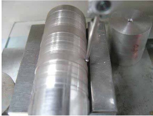
Figura 3.19. Medição de desgaste do rebolo através da altura dos degraus do corpo de prova em aço.
