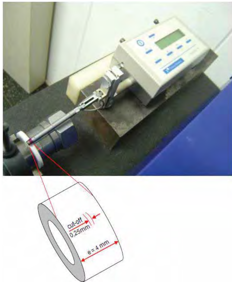
Figura 3.16. Operação de medição de rugosidade.
