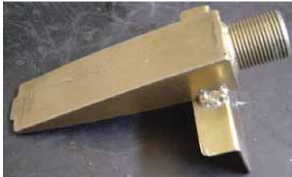
Figura 3.6. Bocal fabricado para a técnica de lubri-refrigeração otimizada
