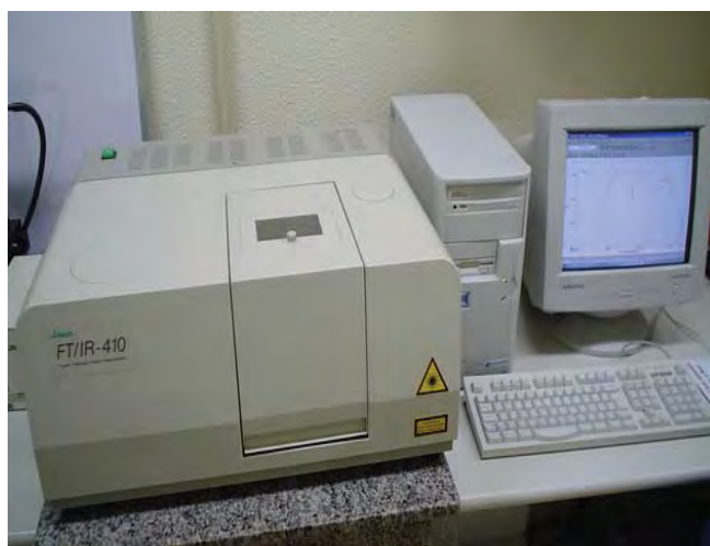
Figura 2.10.4.4 – Espectrômetro JASCO FTIR-410. (Imagem de domínio público disponível em: < http://www.sorocaba.unesp.br/gpm/Estrutura.htm >. Acesso em 24/08/2011).
