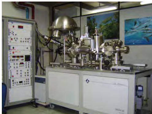
Figura 2.10.5.3 – Foto do equipamento utilizado nas análises das amostras por XPS. (Cortesia do Prof. Dr. Wido H. Schreiner do Laboratório de Superfícies e Interfaces do Departamento de Física da Universidade Federal do Paraná).
