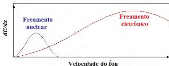
Figura 2.5.2 – Gráfico de dE/dx em função da velocidade do íon v_i = (2m_i E_k)^{1/2} mostrando o comportamento de uma partícula cruzando o alvo em relação das suas componentes (dE/dx)_n e (dE/dx)_e [29] .
