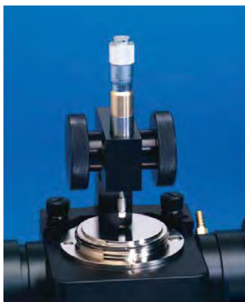
Figura 2.10.4.5 – Fotografia do acessório ATR. (Imagem do catálogo eletrônico do fabricante PIKE Technologies, Inc disponível em: < http://www.piketech.com/products/atr.html >. Acesso em 16/01/2011).
