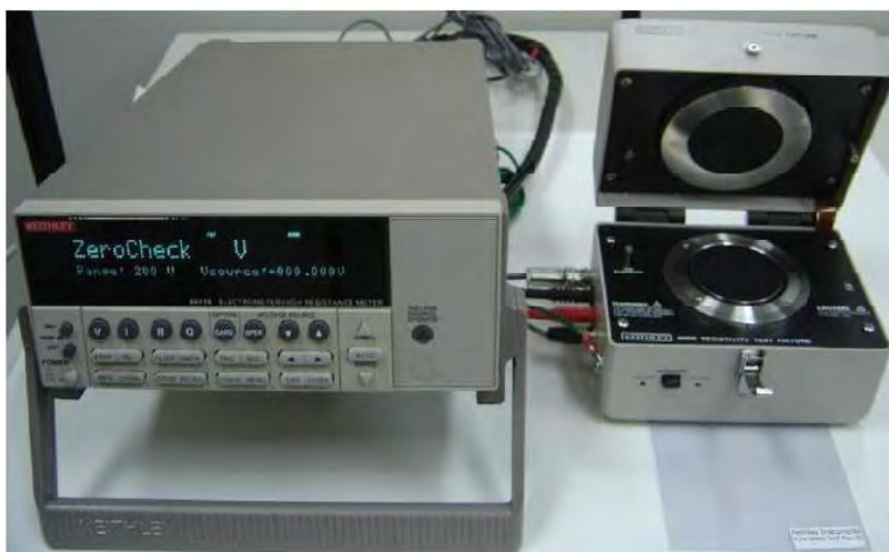
Figura 2.10.6.2 – Foto do eletrômetro (Keithley-6517A) e do acessório (Keithley-8009) usado na determinação da resistividade superficial das amostras. (Reproduzido da referência [24] com permissão do autor)
