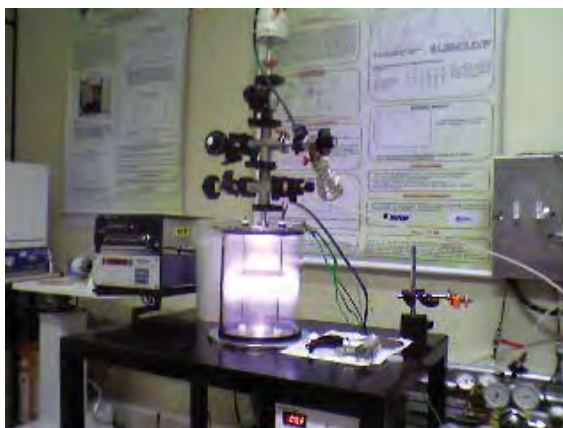
Figura 2.6.1 – Fotografia de um reator a plasma com corpo de vidro em funcionamento mostrando os eletrodos num arranjo capacitivo e o plasma entre eles. (Cortesia do LaPTec – Laboratório de Plasma Tecnológico – UNESP – Campus Experimental de Sorocaba).
