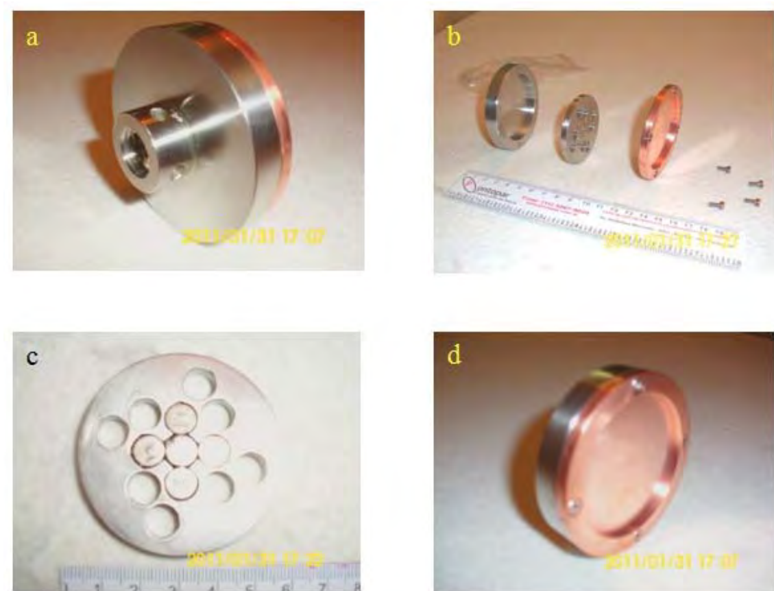
Figura 3.3.2 – Detalhes construtivos do eletrodo de Magnetron: (a) Foto do conjunto montado visto pelo lado do suporte; (b) Panorâmica dos componentes (da esquerda para direita) suporte do eletrodo, disco de distribuição dos ímãs, alvo de cobre e os parafusos de fixação do alvo; (c) disco distribuidor dos ímãs já com os ímãs de NdFeB montados; (d) Foto do conjunto montado visto pelo lado do alvo de cobre.
