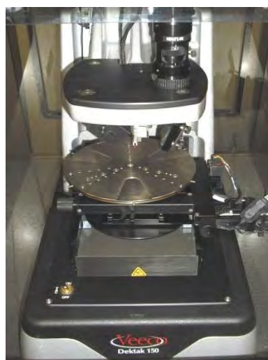
Figura 2.10.1.1 – Fotografia do perfilômetro utilizado nas medidas de espessura e rugosidade. (Imagem de domínio público obtida em: http://www.upc.edu/pct/en/equip/399/mechanical-profilometer.html . Acesso em 18/08/2011).
