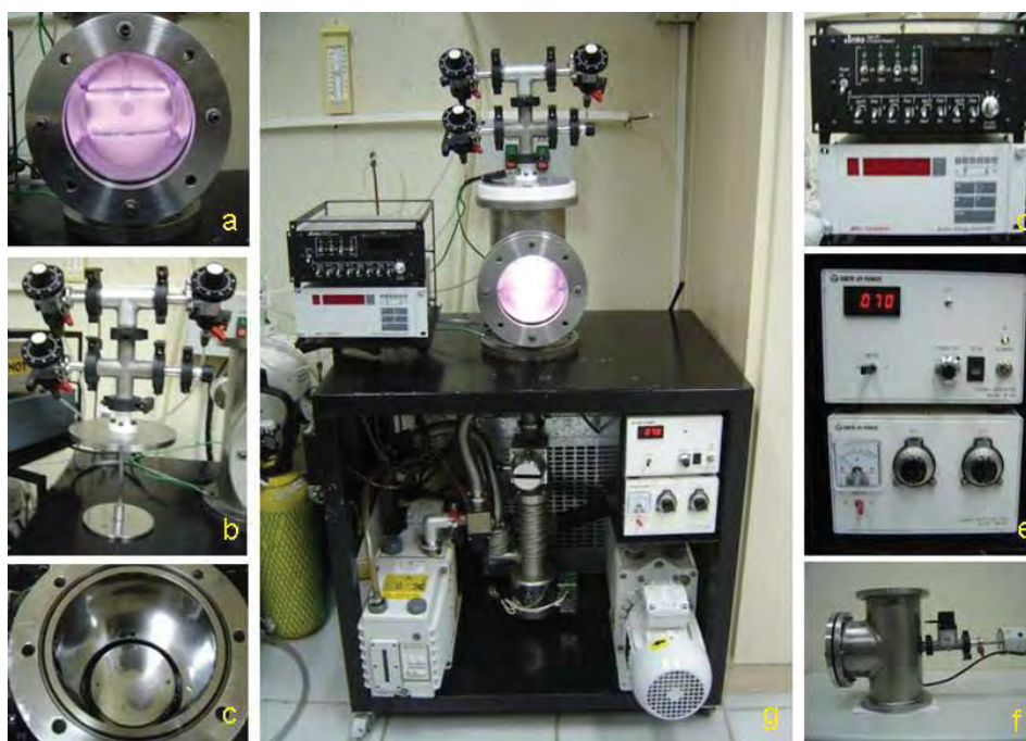
Figura 3.3.1 – Foto do reator e acessórios do sistema utilizado em todos os tratamentos realizados. (a) Arranjo dos eletrodos e o plasma; (b) Válvulas agulhas acopladas à tampa, isolada por um conector de Teflon e o eletrodo superior; (c) interior da câmara com o eletrodo inferior; (d) Indicador de pressão; (e) Fonte de rf e o casador de impedância; (f) Sensor de pressão acoplado à câmara; (g) Vista geral mostrando os sistemas de controle e a bomba de vácuo. (reproduzido da referência [24] com permissão).
