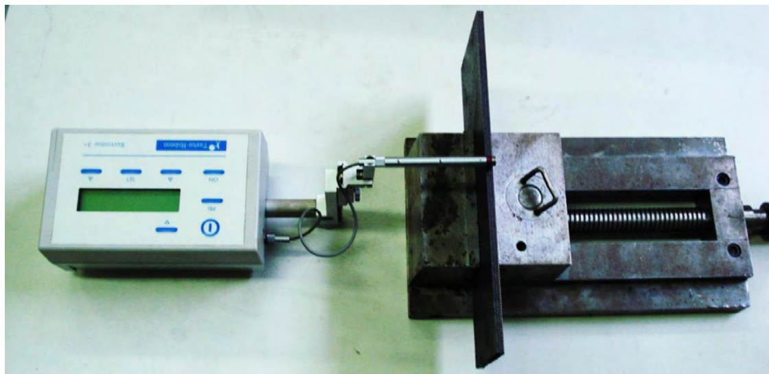
Figura 4.19 - Medição de rugosidade.
