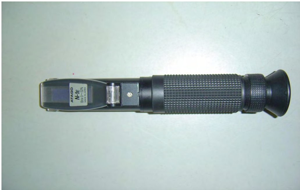
Figura 4.18 - Refratômetro ATAGO N-50E, utilizado para verificação da concentração do fluido de corte do método convencional.
