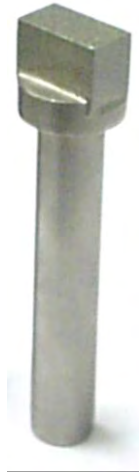
Figura 4.4 - Dressador do tipo conglomerado utilizado nesta pesquisa.
