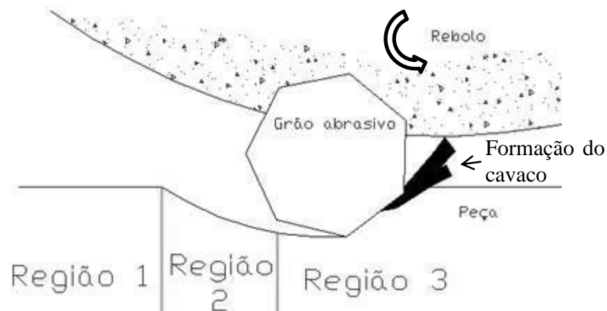
Figura 3.11 - Formação do cavaco por um grão abrasivo, (KÖNIG,1980 e MALKIN, 1989, adaptada)
