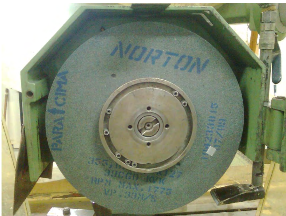
Figura 4.3 - Rebolo convencional de carbeto de silício fixo ao eixo árvore da máquina.
