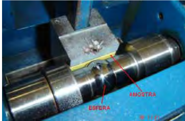
Figura 31 – Detalhe da esfera atuando na placa durante o ensaio.
