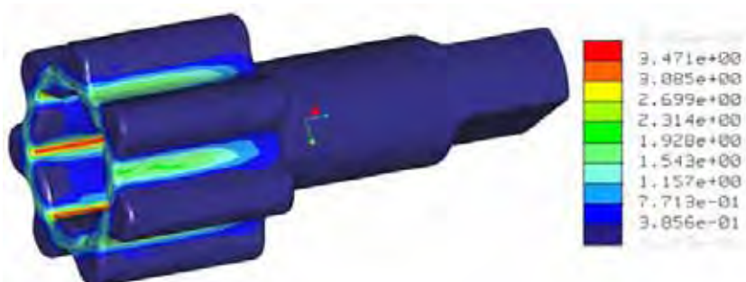
Figura 66 – Análise FEA do eixo integrado ao rotor interno: Tensão de Von Mises (MPa)
