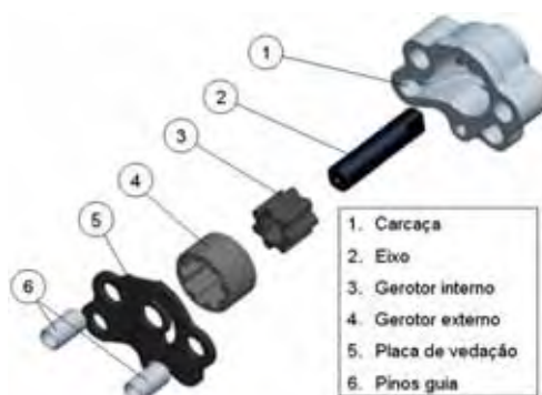
Figura 7 – Bomba de óleo para motocicletas – esquema.
