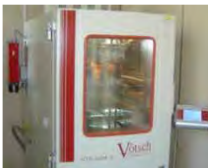
Figura 22 – Câmara climática para ensaios de envelhecimento, contendo em seu interior os recipientes de vidro com as amostras
