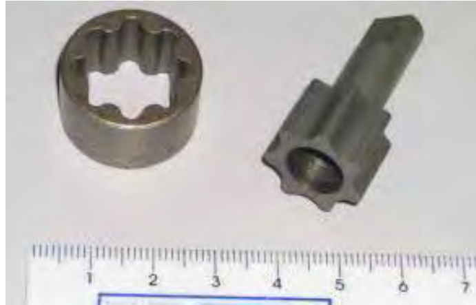
Figura 70 – Rotor externo e rotor interno integrado ao eixo no design proposto, conforme projetado para a eventual peça em compósito, porém fabricadas em aço 100Cr6.
