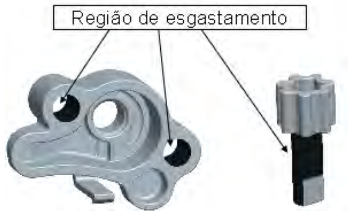
Figura 31 – Detalhe do desgaste (escuro), travando nos furos (carcaça) e no corpo cilíndrico (eixo) todos os graus de liberdade
