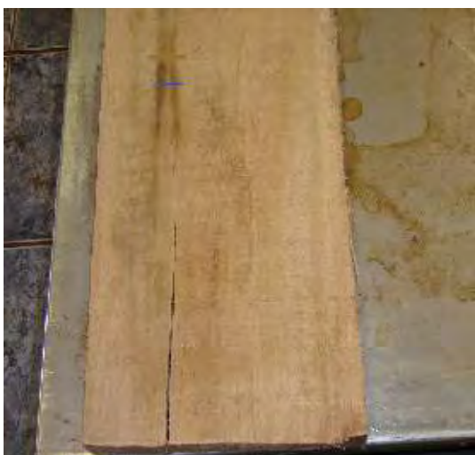
Figura 19. Medição das rachaduras de topo das tábuas de Hevea brasiliensis .
