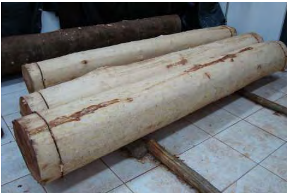
Figura 12. Toras de Hevea brasiliensis após a remoção da casca.
