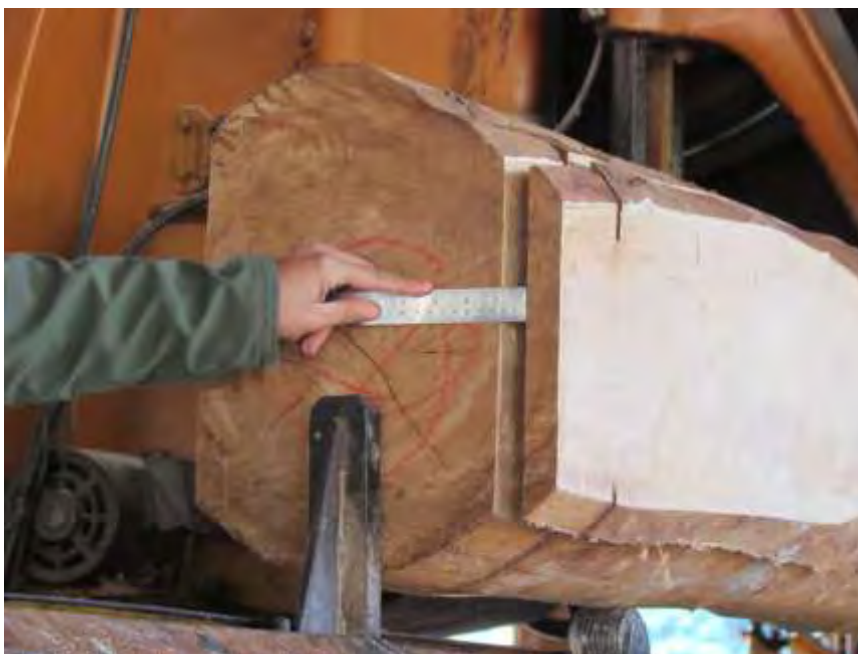
Figura 18. Medição da abertura da tábua em relação à tora de Hevea brasiliensis durante o desdobro.
