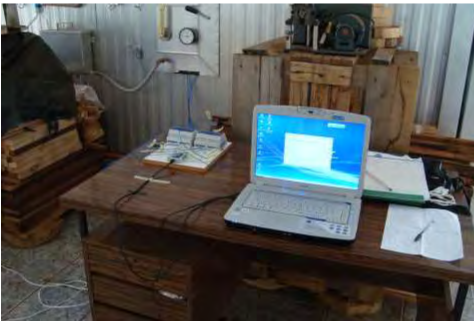
Figura 14. “Datalogger” acoplado aos termopares inseridos nas toras de Hevea brasiliensis .
