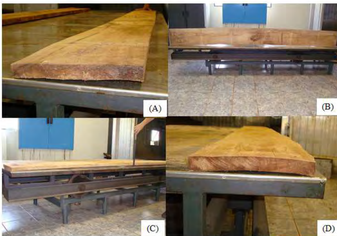
Figura 20. Medição dos empenamentos após desdobro: torcimento (A), arqueamento (B), encurvamento (C) e encanoamento (D).
