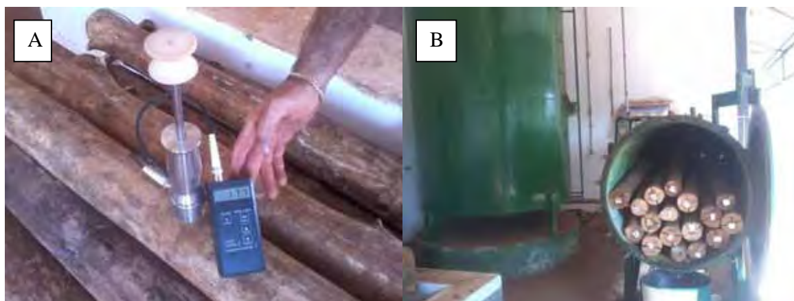
Figura 6. Abastecimento da autoclave para realização do processo de preservação: A – Medição da umidade da madeira antes da entrada na autoclave; B – Mourões dispostos dentro da autoclave, prontos para início do ciclo de preservação.
