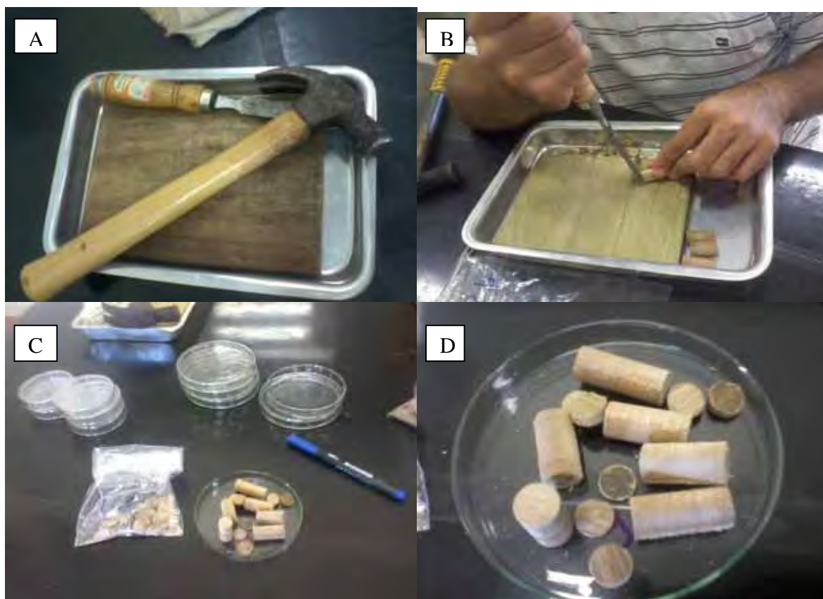
Figura 9. Preparo das baguetas para secagem e posteriormente para cálculo da massa específica seca do alburno de cada mourão: A – Material utilizado para ajuste; B – Ajuste das arestas sendo realizado com auxílio de formão; C e D – Amostras prontas para a secagem em estufa.
