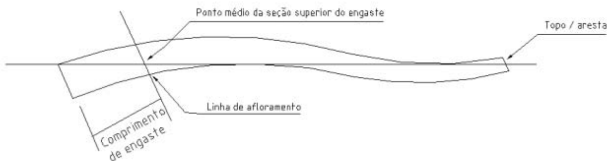
Figura 2. Limite máximo de curvatura em dois planos e em duas direções estipulado pela norma ABNT NBR 9480 (2009).
