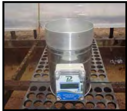
Figura 5. Pluviômetro eletrônico utilizado na aferição dos bocais de irrigação dentro dos túneis de aplicação das lâminas brutas e frequências de irrigação.
