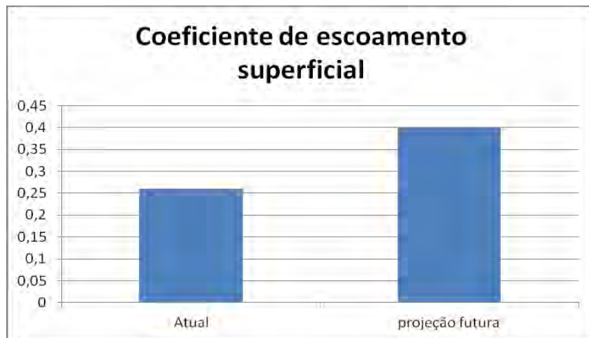
Figura 20 - Gráfico da variação do coeficiente de escoamento superficial na microbacia do córrego da Cachoeirinha.
