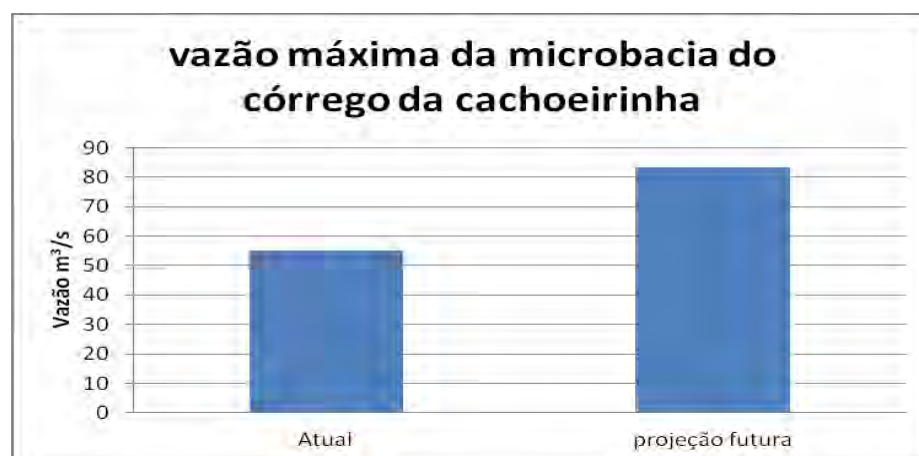
Figura 21 - Gráfico da vazão máxima da microbacia do córrego da Cachoeirinha com os usos e ocupação dos solos atual e para uma projeção futura.
