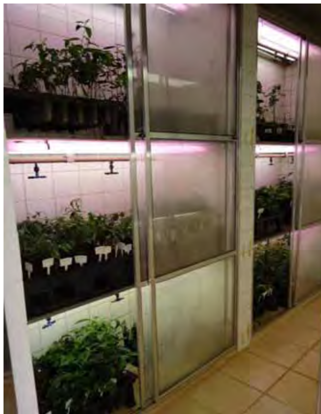
Figura 4. Câmara de Ambiente Controlado.
