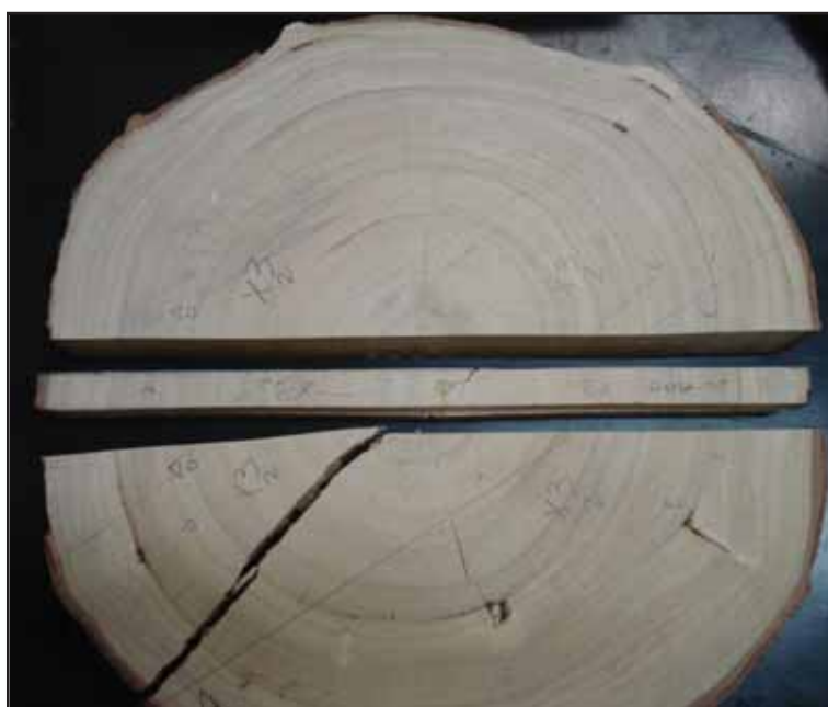
Figura 8. Visualização das camadas de crescimento, detectáveis no disco de árvores sadias destinado ao estudo de madeira juvenil e adulto
