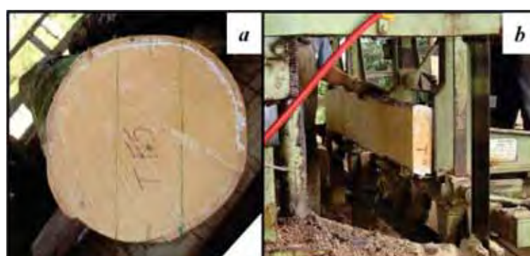
Figura 3. (a) - Linhas de corte na seção transversal no topo da tora; (b) - desdobro da tora em pranchão contendo a medula da árvore
