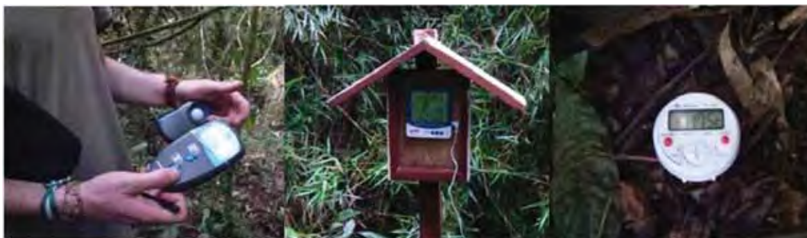
Figura 6. Equipamentos utilizados na medição do microclima: termohigrômetro (temperatura e umidade relativa do ar) protegido com uma estrutura de madeira; luxímetro digital (intensidade luminosa); termômetro de solo (temperatura do solo).
