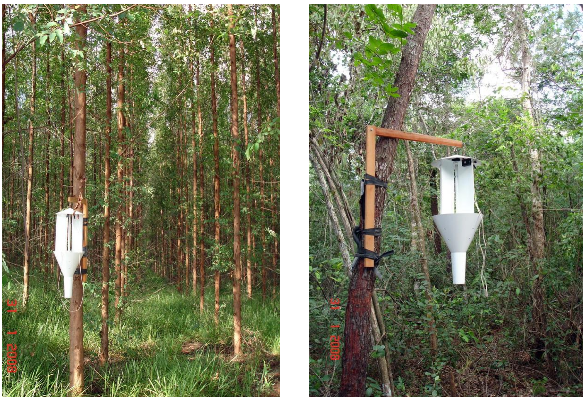
Figura 3. Armadilha luminosa utilizada no levantamento de insetos das ordens Lepidoptera e Coleoptera nos diferentes habitats estudados.
