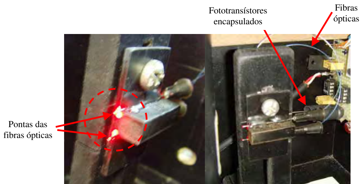
Figura 4.8 – Detalhe da fixação das fibras ópticas
