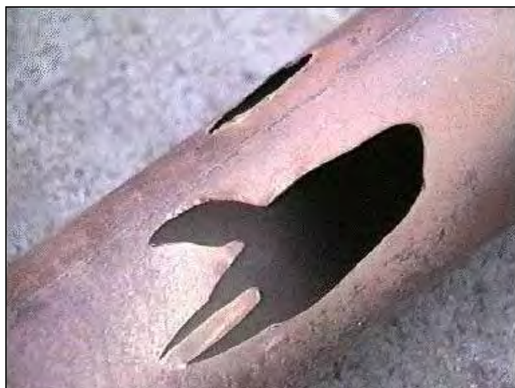
Figura 2.2 – Fenômeno da erosão em um tubo de transporte pneumático de partículas em fase diluída. Disponível em: http://www.erpt.org/014Q/rhoe-00.htm .
