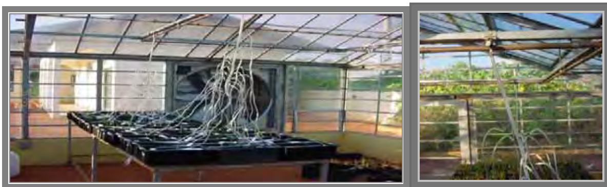
Figura 5. Detalhes do sistema de aeração constituído por mangueiras plásticas individuais para os vasos e fixas por agulhas em mangueiras de silicone, conectadas em um registro na tubulação de distribuição de ar proveniente do compressor. Botucatu, 2006.
