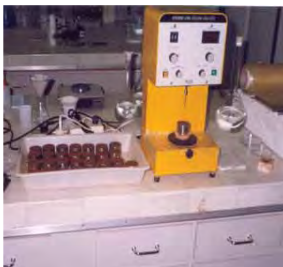
Figura 5. Aparelho Texture Analyser, pertencente ao Laboratório de Pós-colheita do Departamento de Horticultura da FCA-UNESP, usado para a determinação da resistência à penetração em anéis contendo amostra indeformada de solo.
