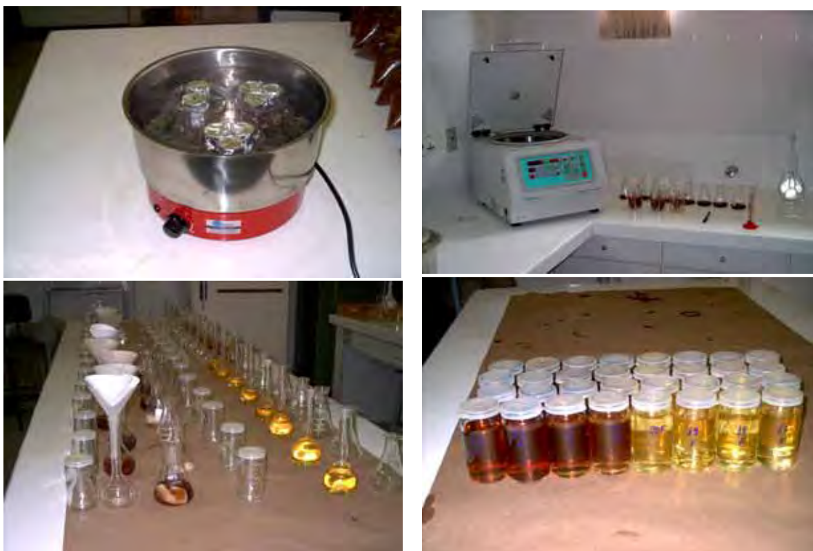
Figura 6. Etapas do fracionamento da matéria orgânica: canto superior esquerdo – tubos de centrifuga tampados com papel alumínio contendo pequeno orifício no centro; canto superior direito – centrifugação e coleta do sobrenadante; canto inferior direito - filtração de separação dos extratos contendo as frações AF e AH.
