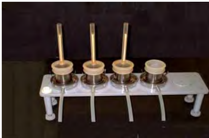
Figura 4. Permeâmetro de carga variável, pertencente ao Laboratório de Física do Solo, do Departamento de Solos – Recursos Naturais da FCA-UNESP
