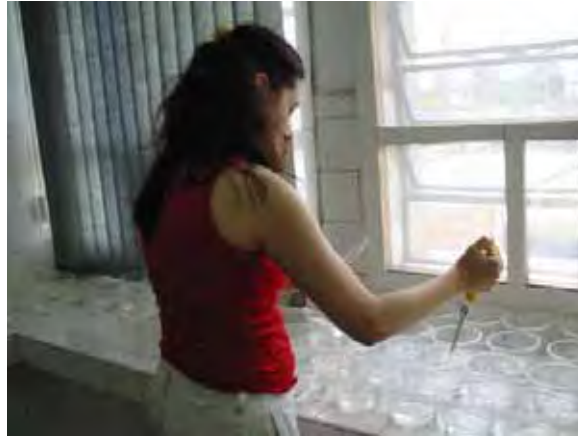
Foto 11 - Adição das diluições de cada produto nos potes com 150 mL de água.
