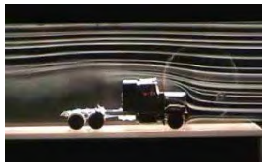
(d) Visualização do escoamento de ar em torno de um modelo de caminhão. Fonte: Auld e Srinivas (2006).
