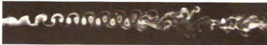
Figura 16 – Transição na esteira.
