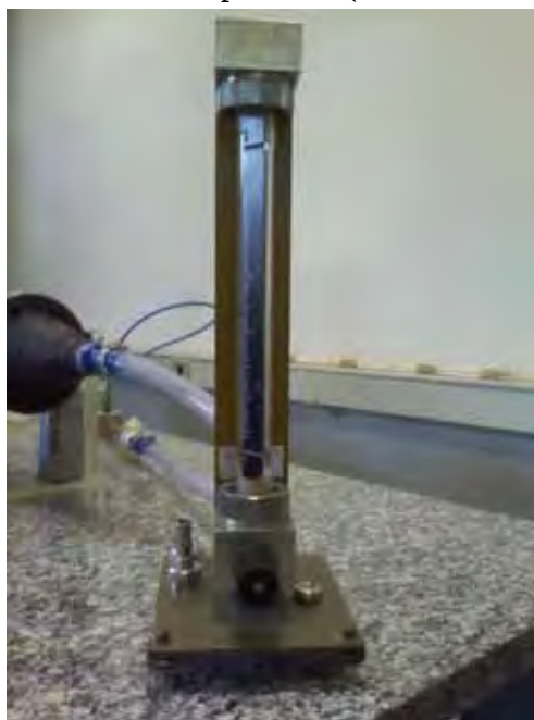
Figura 47 – Rotômetro de precisão (1% de fundo de escala).
