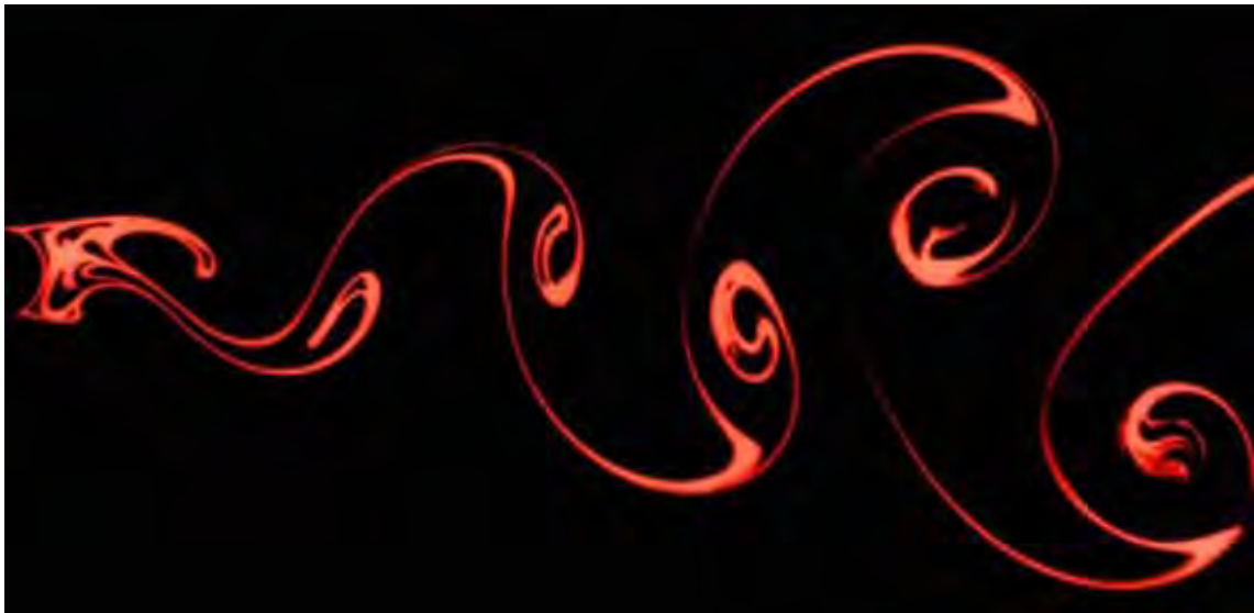
Figura 3 – Emissão alternada de vórtices a jusante de um corpo rombudo.
