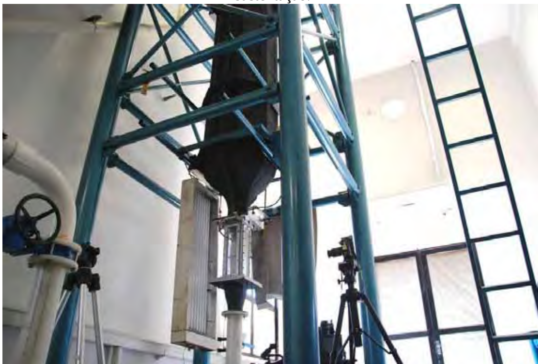
Figura 20 – Vista do túnel hidrodinâmico mostrando a seção de testes e parte da estrutura de sustentação.
