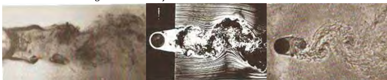
Figura 17 – Transição nas camadas cisalhante livres.
