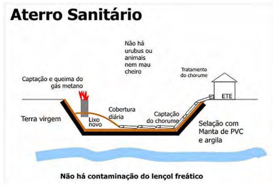
Figura 7 – Esquema de um aterro sanitário com queima dos gases gerados e com sistemas de controle de poluentes gasosos e líquidos.
