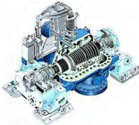
Fonte: Centro de Estudos em Economia da Energia dos Transportes e do Ambiente (Org.) (2010) Figura 19 – Turbina a vapor de contra-pressão em corte, mostrando o conjunto de palhetas e rotor.
