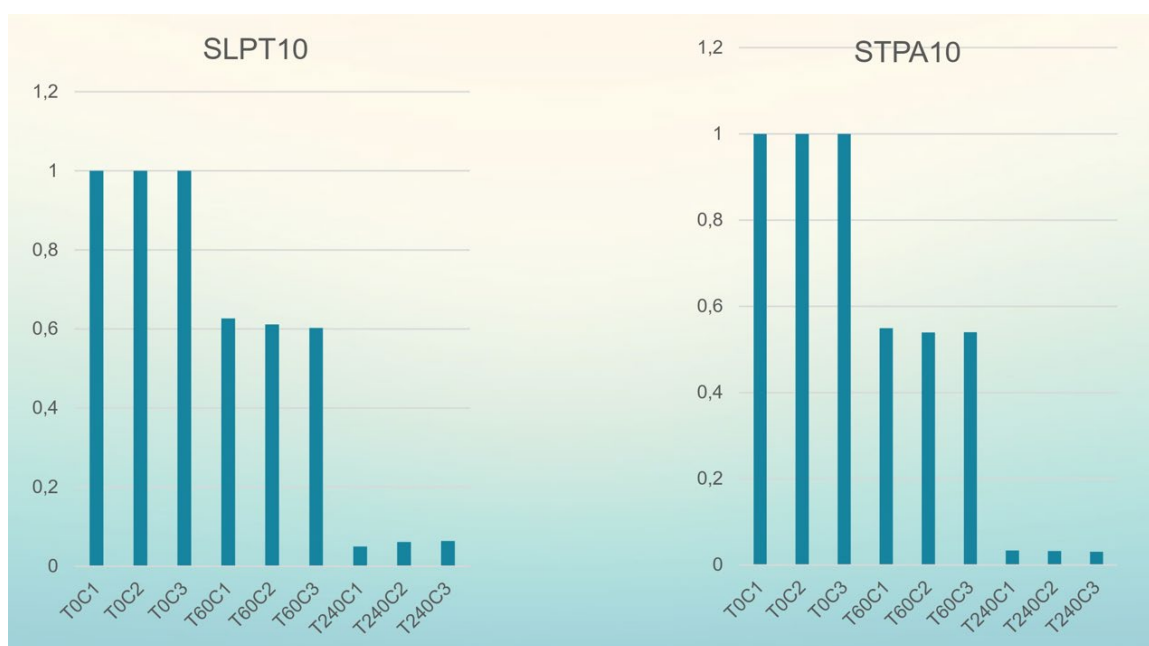
Figura 26. Análise da desativação do catalisador ao longo de três ciclos de reutilização. As barras comparam a absorbância da solução de RhB em tempos de reação fixos (0, 60 e 240 minutos) para cada um dos três ciclos. O aumento progressivo da absorbância para um mesmo tempo de reação em ciclos subsequentes demonstra a gradual perda de eficiência do fotocatalisador.
