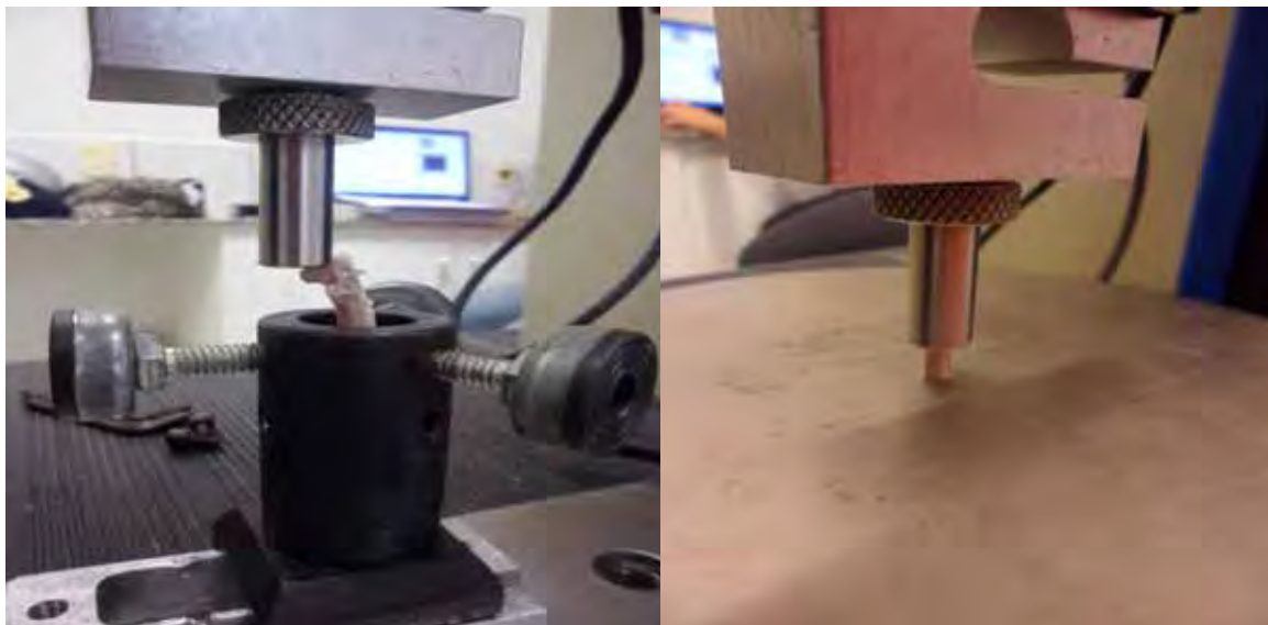
Figura 7 Ensaio mecânico de compressão do fêmur
