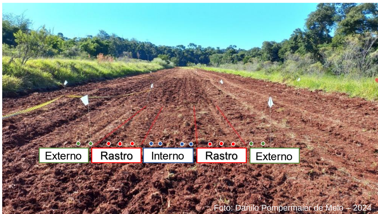
Figura 7 – Transecto de coleta de resistência do solo à penetração
