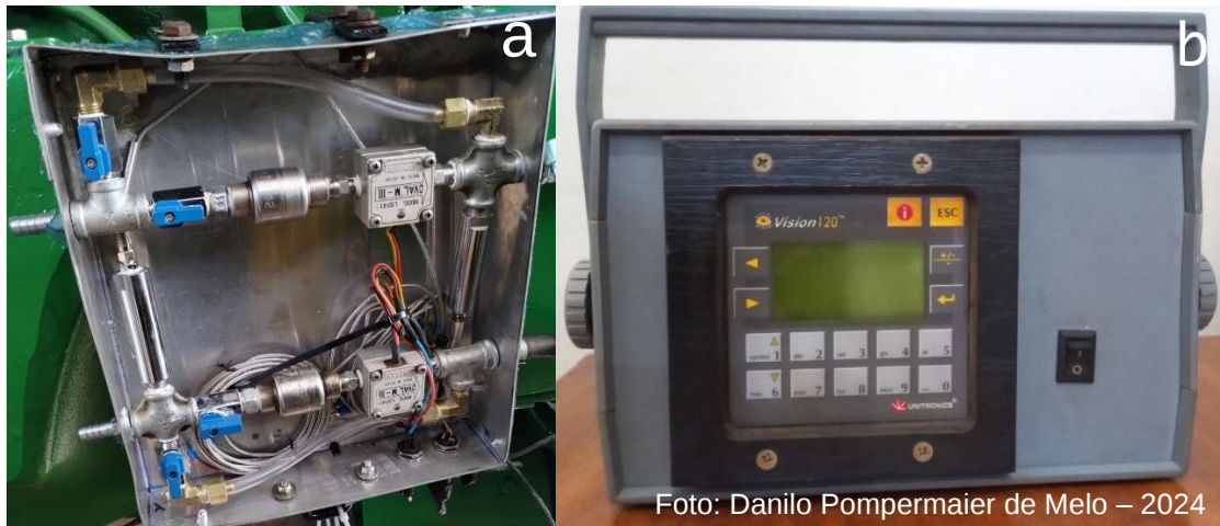
Figura 5 – (a) Fluxômetros instalados no sistema de combustível do trator. (b) CLP para coleta de dados dos fluxômetros
