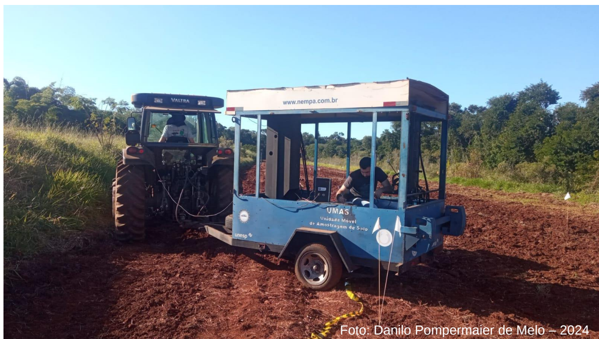
Figura 6 – Unidade Móvel de Amostragem de Solo
