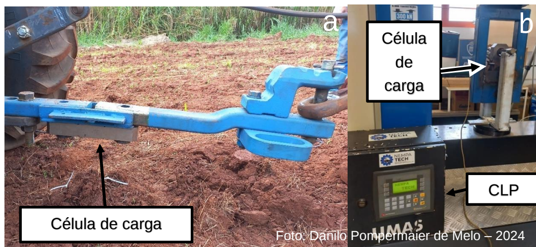
Figura 4 – (a) Barra de tração adaptada para coleta de força. (b) Calibração da célula de carga junto ao CLP
