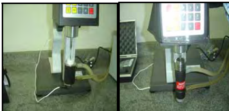
Figura 11 – Viscosímetro rotacional do tipo Brookfield as amostras, à esquerda ULA com 16,0 mL de nanoemulsão e, à direita, o SDC 34 com 8,0 mL de macroemulsão.
