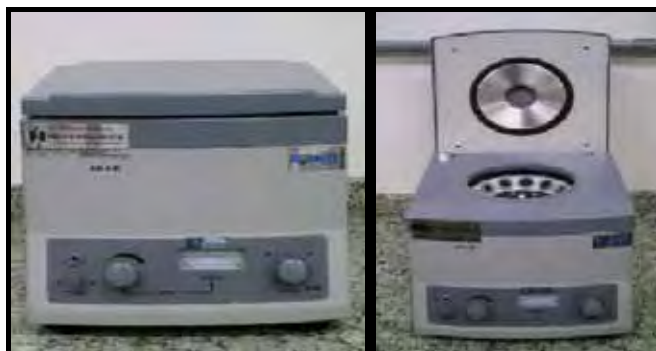
Figura 12 – Centrífuga utilizada no ensaio de floculação.
