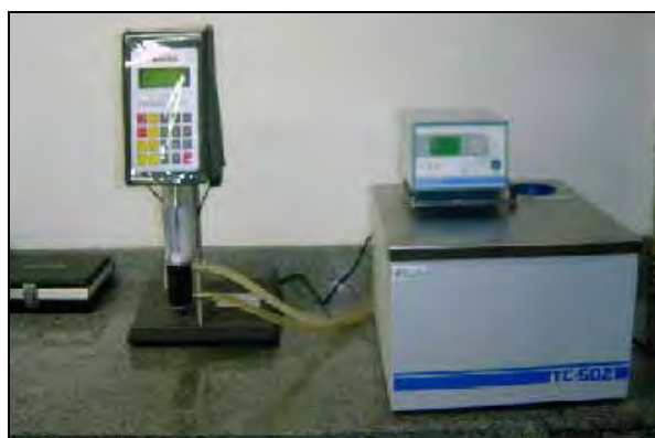
Figura 10 – Viscosímetro rotacional do tipo Brookfield com banho termostático.
