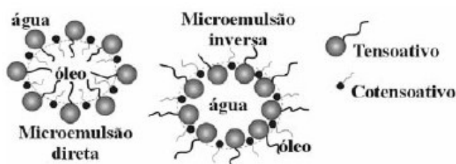
Figura 7 – Estrutura de microemulsão O/A e A/O.
