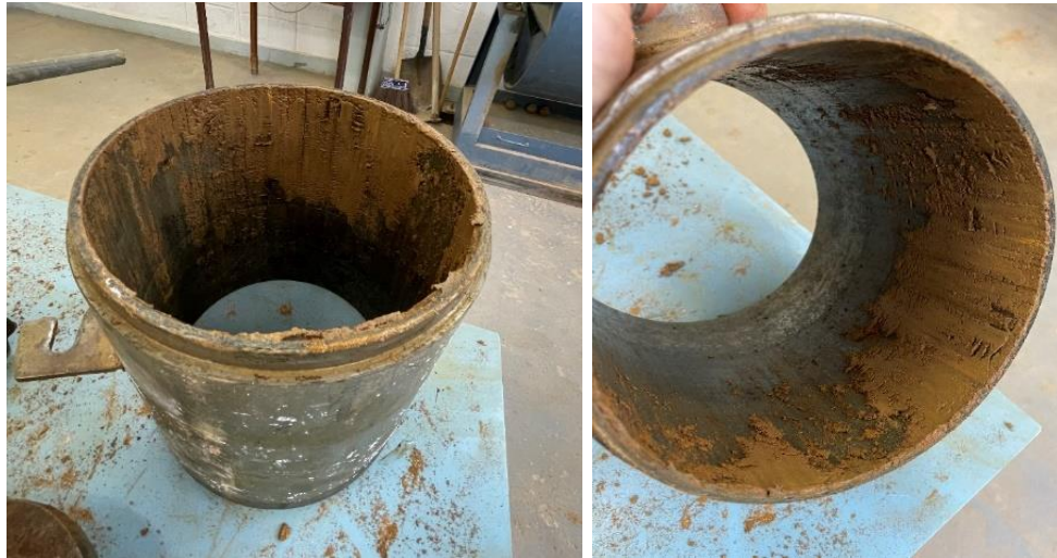
Figura 34 – (a) Cilindro com solo fortemente aderido às bordas internas, após extração do corpo de prova imerso e ensaiado para obtenção do ISC. (b) cilindro visto sob outro ângulo.
