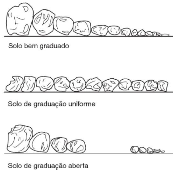
Figura 4 – Visualização esquemática dos três diferentes tipos de distribuições granulométricas, representadas pelas curvas A, B e C.
