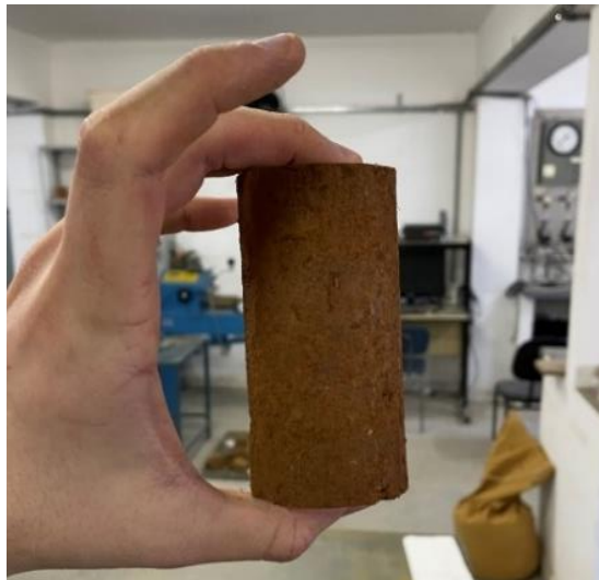
Figura 12 – Corpo de prova moldado para o ensaio de determinação da RCS.
