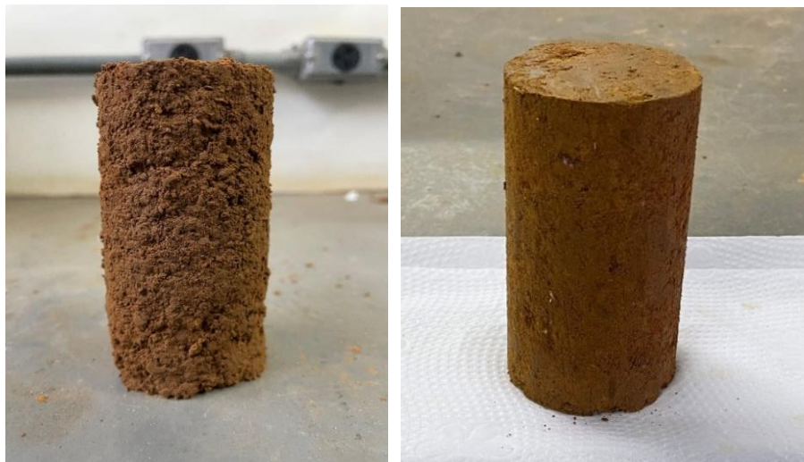
Figura 33 – Corpos de prova moldados para o ensaio de RCS (a) com solo natural – à esquerda; (b) com solo tratado com a solução enzimática – à direita.
