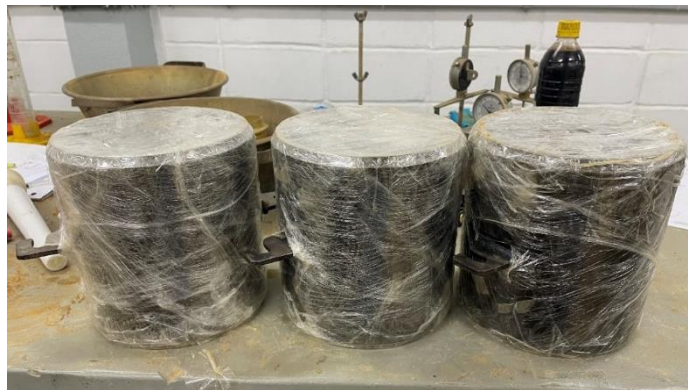
Figura 15 – Corpos de prova moldados para o ensaio de penetração para determinação do ISC.
