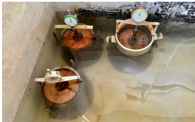
Figura 16 – Corpos de prova imersos em água por 4 dias com relógio medidor de deslocamento.
