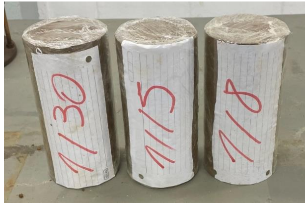
Figura 18 – Corpos de prova moldados para o ensaio triaxial dinâmico de carga repetida para determinação do MR.
