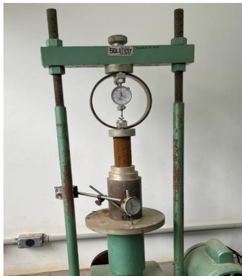
Figura 14 – Ensaio de aplicação de carga axial não confinada para obtenção da RCS.
