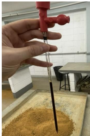
Figura 10 – Pipeta com precisão de 0,01 ml usada para medir o volume de solução enzimática.
