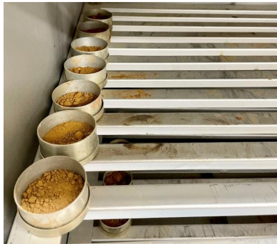
Figura 11 – Cápsulas com amostras de solo com diferentes teores de umidade, levadas à estufa por 24h.
