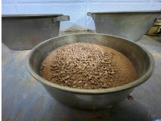
Figura 9 – Amostra de solo preparadas conforme NBR 6457/2016.
