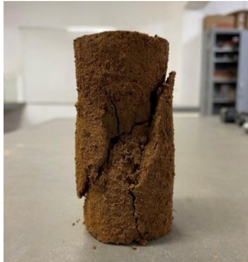
Figura 13 – Corpo de prova rompido após o ensaio para obtenção da RCS.
