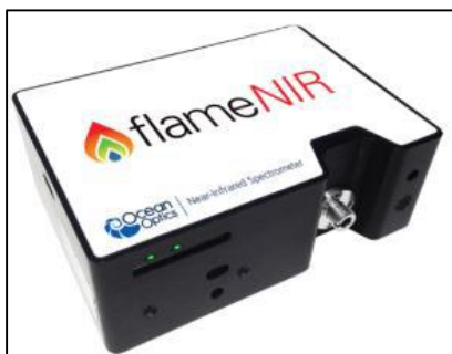
Figura 7 - Espectrorradiômetro da Ocean Optics, modelo Flame – NIR (faixa de leitura de 966,03nm a 1685,09nm, com sensibilidade de 5,51nm) utilizado para a obtenção da reflectância foliar das mudas de Eucalyptus urophylla
