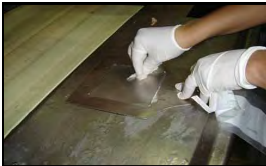
Figura 3 - Colheita de amostra de superfície de contato – Mesas (P5 e P11).
