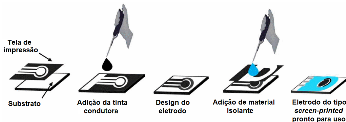
Figura 3 - Etapas do processo de produção dos eletrodos do tipo screen-printed . Fonte: adaptado de Pérez-Fernández et al. [71]. Reproduzido sob política de acesso aberto, MDPI.
