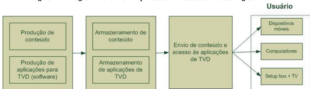
Figura 4.1 – Diagrama Funcional Simplificado em Blocos da Televisão Digital
