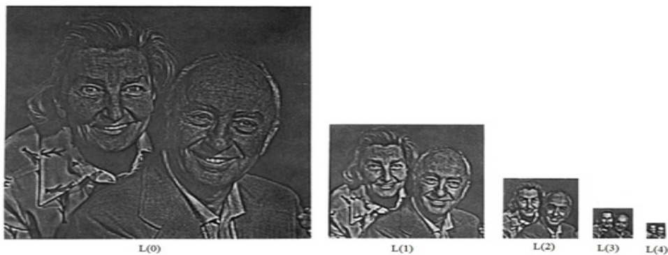
Figura 2.7: Pirâmide Laplaciana, cada nível representa a diferença entre dois níveis sucessivos da pirâmide Gaussiana. Extraído de (ADELSON et al., 1984)
