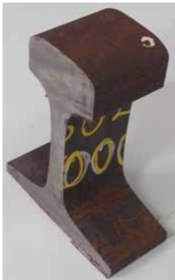
Figura 54 - Trilho reduzido a 65 mm.
