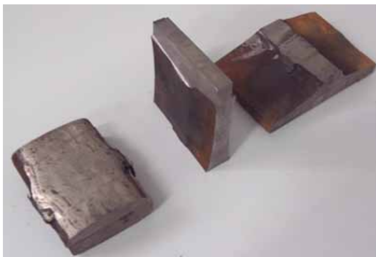
Figura 55 - Trilho soldado após cortes longitudinais.
