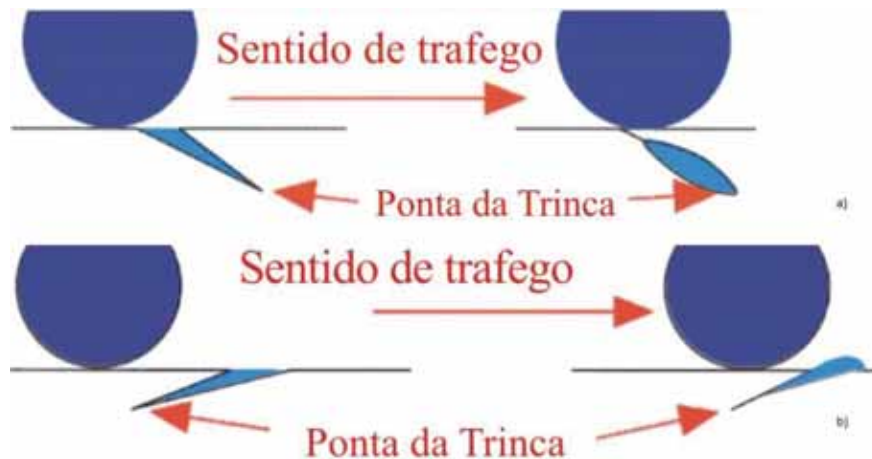
Figura 49 - Desenho esquemático do squashed balloon . a) tráfego aprisionando o fluido e b) tráfego liberando o fluido. [39]
