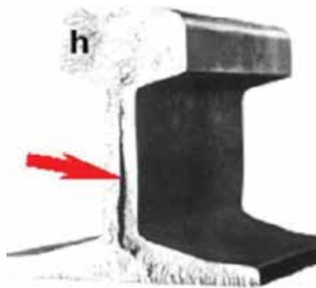
Figura 17 - Exemplo de trinca vertical na alma. [18]
