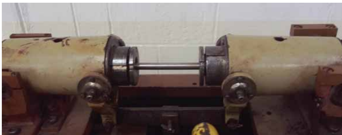
Figura 69 - Corpo de prova de fadiga posicionado na máquina.
