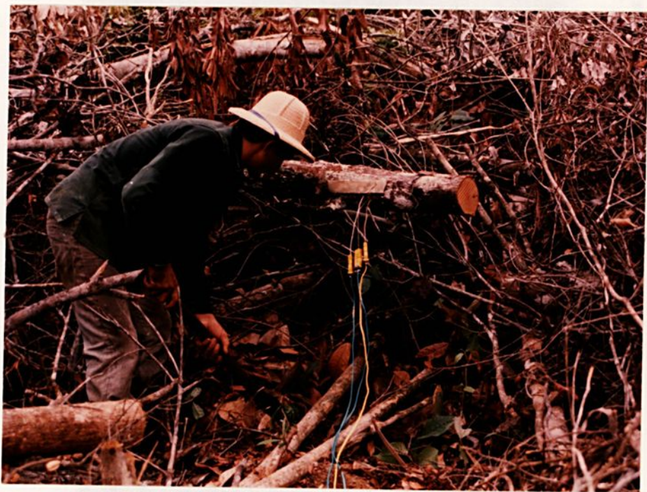
Fig. A.10 - Tronco T47 instrumentado com três termopares antes da queimada.
