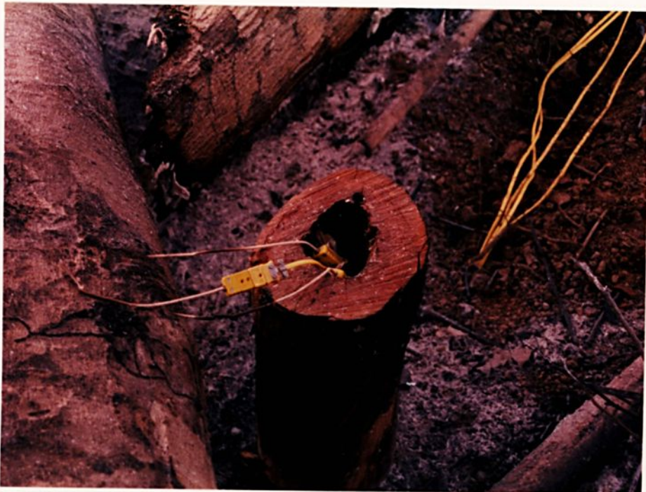
Fig. H.6 - Aspecto dos termopares instalados no T93.
