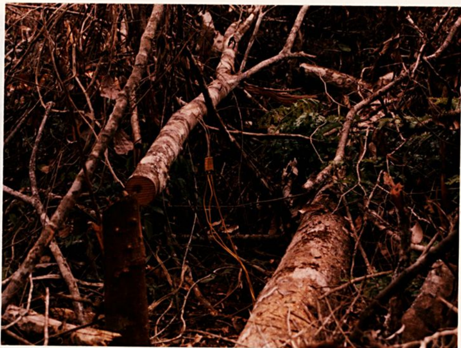
Fig. A.9 - Tronco T46 instrumentado com três termopares antes da queimada.
