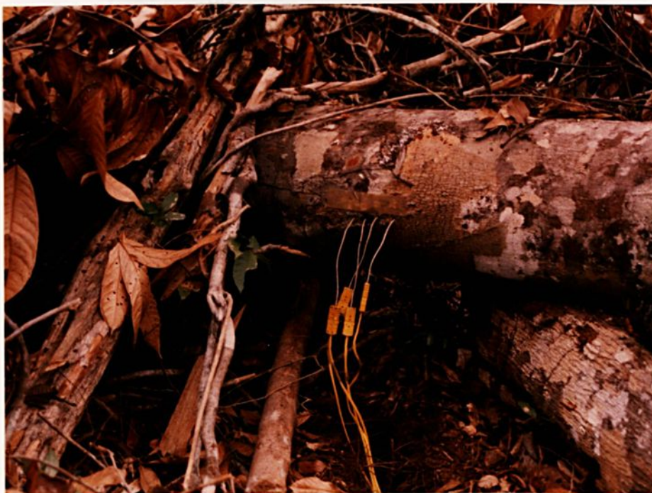
Fig. A.11- Tronco T93 instrumentado com quatro termopares antes da queimada.
