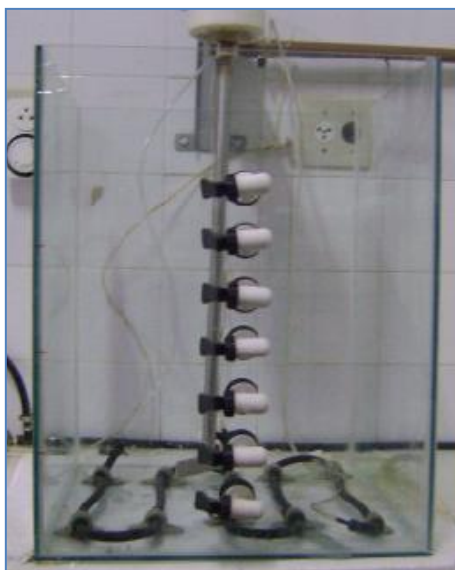
Figura 13. Torneiras para esvaziamento do sistema.
