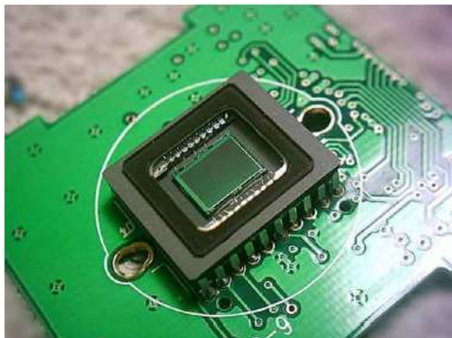
Figura 5. Sensor CCD junto a um circuito de uma câmera digital. Fonte: Esteves (2011).
