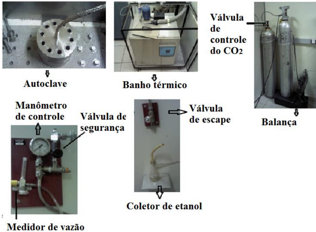
Figura 4: Representação do sistema de controle da autoclave.
