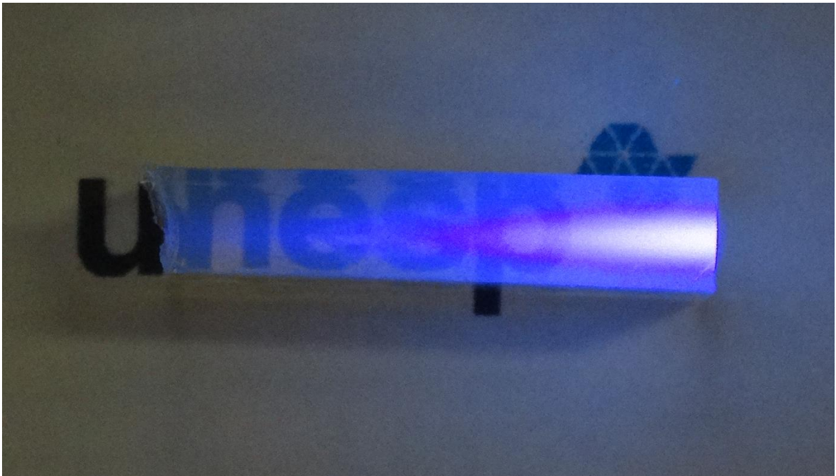
Figura 14: Foto ilustrativa que representa o espalhamento de luz com comprimento de onda: 405 nm.
