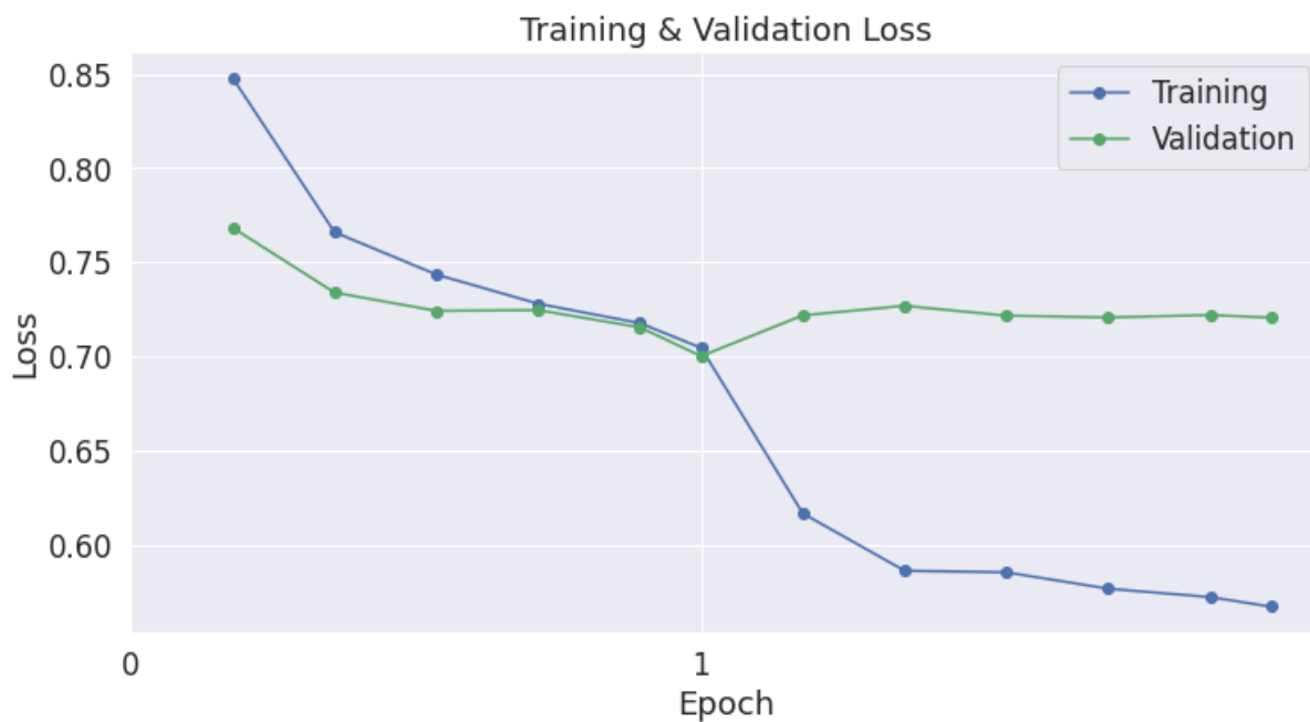
Figura 83 – Curva de aprendizado do BERT treinado, conforme a loss de entropia cruzada. Os valores de treinamento referem-se à loss média nos últimos 200 mil exemplos vistos, enquanto a validação é sempre feita no conjunto completo de validação
