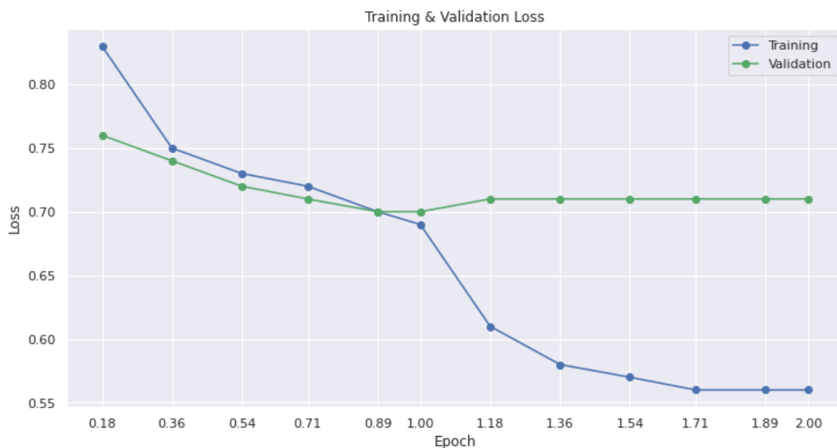
Figura 78 – Curva de aprendizado do BERT treinado, conforme a loss de entropia cruzada. Os valores de treinamento referem-se à loss média nos últimos 200 mil exemplos vistos, enquanto a validação é sempre feita no conjunto completo de validação
