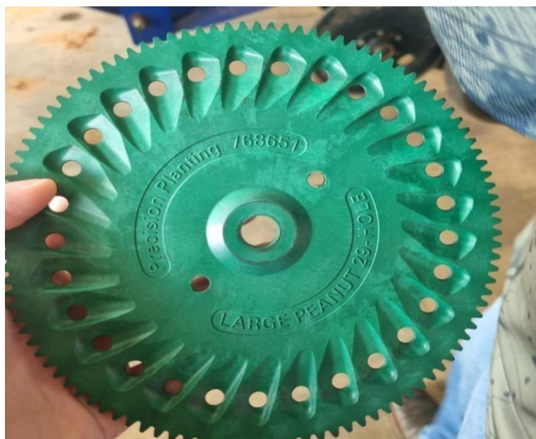
Figura 3. Disco de distribuição de sementes de amendoim utilizado, com 29 furos.
