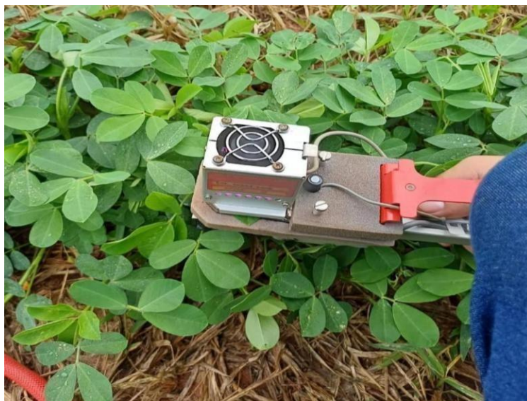
Figura 6. Leitura dos parâmetros de trocas gasosas (IRGA) em R2 do amendoim.
