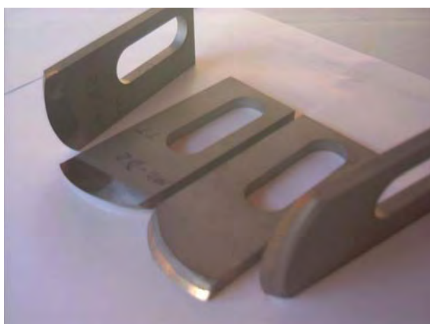
Figura 4.11 – Jogo de ferramentas de desbaste e de acabamento, com pastilha soldada de metal duro.
