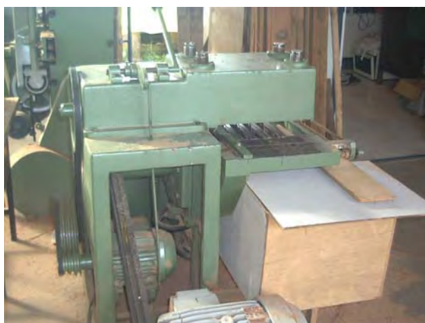
Figura 4.3 - Vista geral da Serra Circular Multilâminas, empregada para usinagem de desdobro das pranchas.
