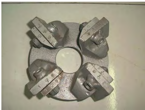
Figura 4.10 - Porta ferramentas e sistema de fixação com detalhe da marcação para posicionamento das facas de desbaste e de acabamento.
