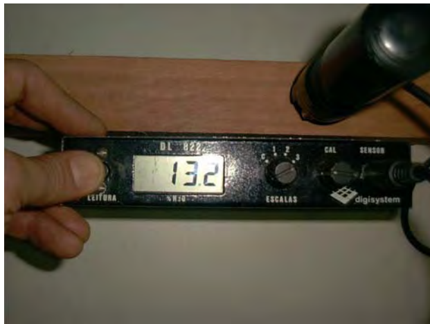
Figura 4.7 - Detalhe de medição de umidade em peça de madeira de Eucalyptus grandis após secagem por ventilação forçada (teor de umidade registrado de 13,2 %).
