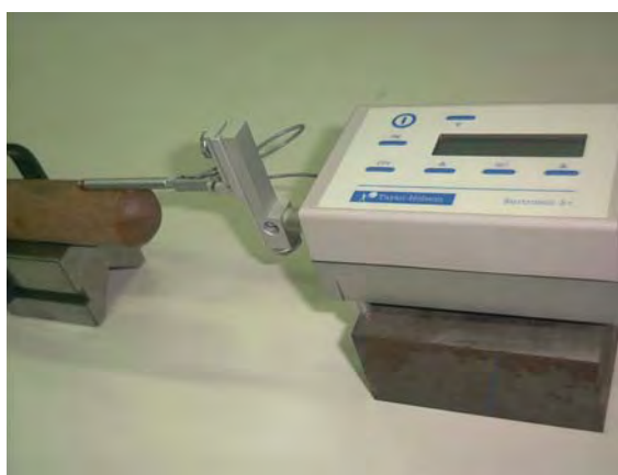
Figura 4.10 - Instrumento de medição da rugosidade, empregado para medição do acabamento superficial das amostras.
