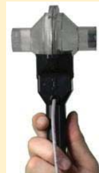
Figura 2: Exemplo de como o transdutor deve ser segurado.
