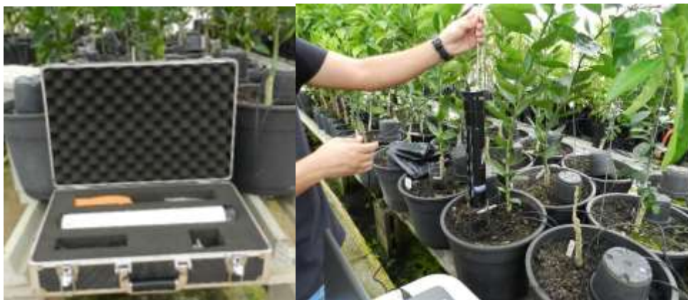
Figura 4. Foto do minirhizotron que foi utilizado para a determinação do crescimento das raízes (Root Scanner CI-600®, CID Bio-Science Inc., Camas, WA, EUA).
