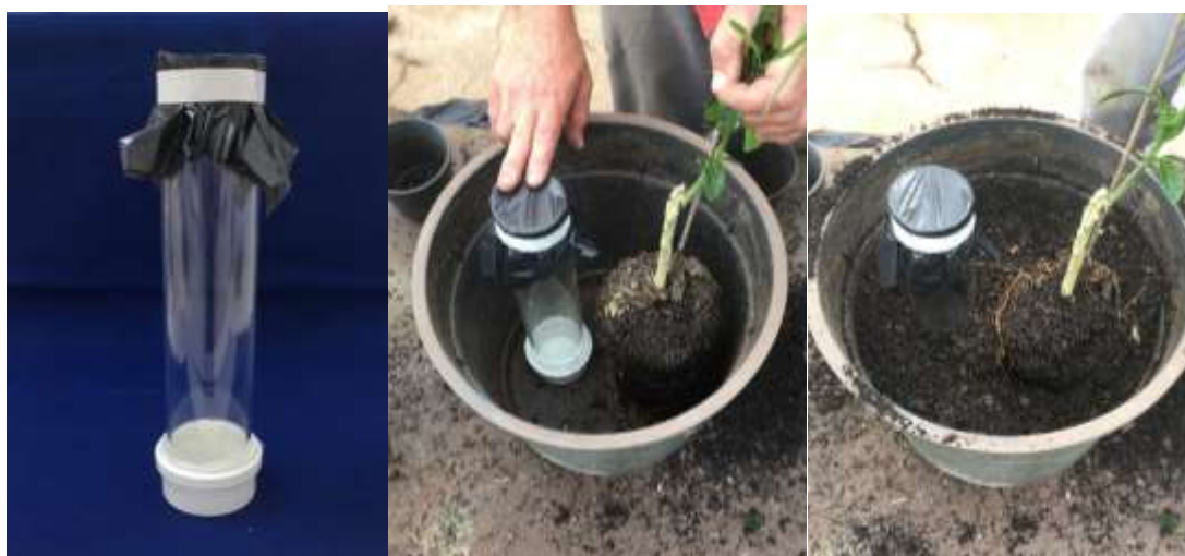
Figura 3. Tubos de acrílico transparentes ( minirhizotron ) que foram instalados nos vasos, próximo ao porta-enxerto no experimento 2.
