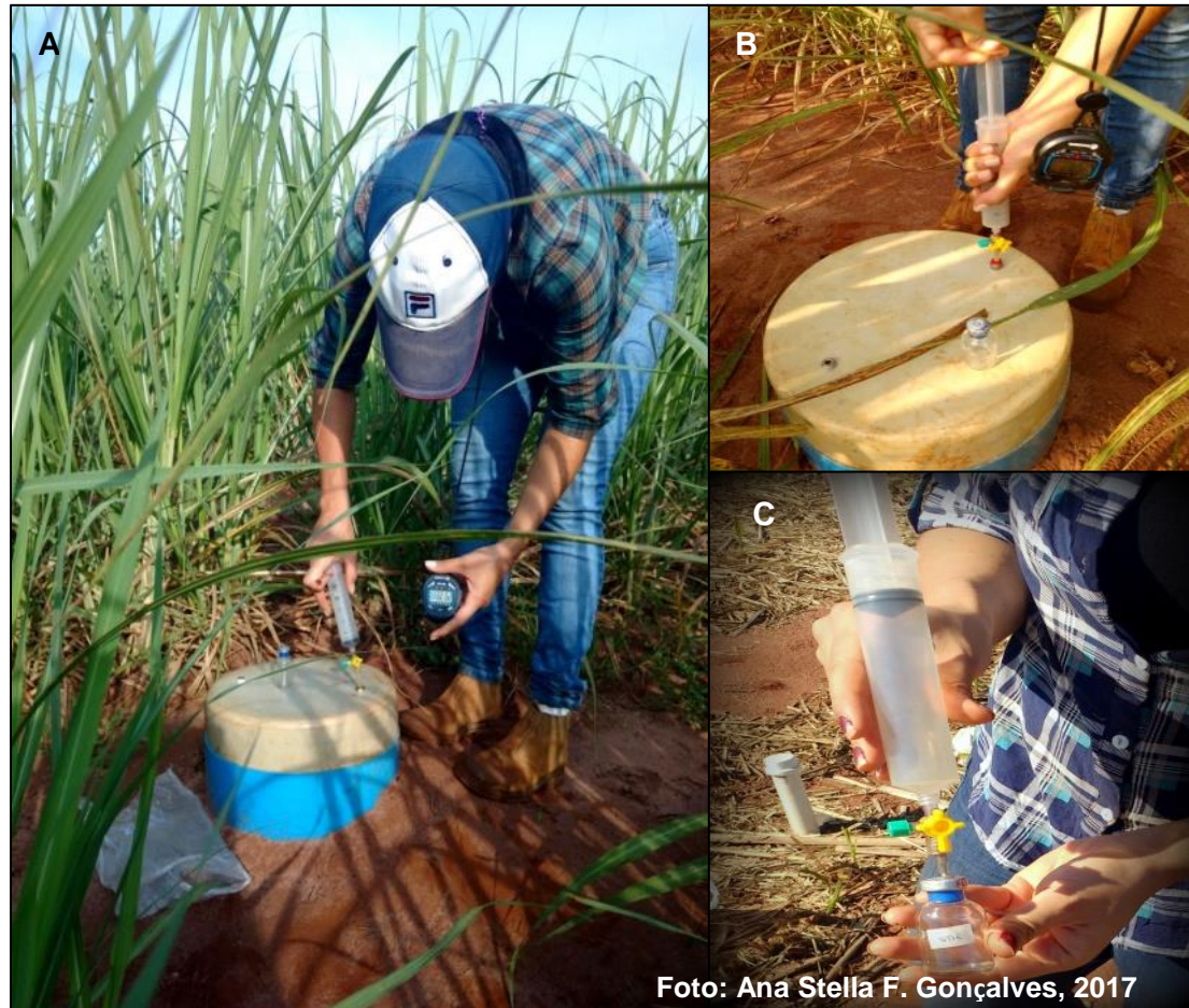
Figura 4 - Detalhes das câmaras estáticas instaladas em campo para a coleta de gases. A: Seringa acoplada à válvula, para realização da coleta. B: Pressurização de gases da câmara para a seringa. C: Transferência de gases da seringa para o frasco. Lençóis Paulista – SP, 2017
