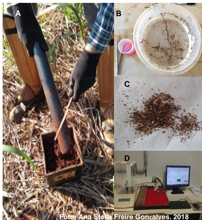
Figura 9 - Procedimento para determinação do C aportado pelo sistema radicular. A: Coleta das amostras de raízes pelo método do trado. B: Separação das amostras após passagem em peneira. C: Amostra após secagem para determinação da matéria-seca e teor de C. D: Preparo de amostras para leitura em analisador elementar automático
