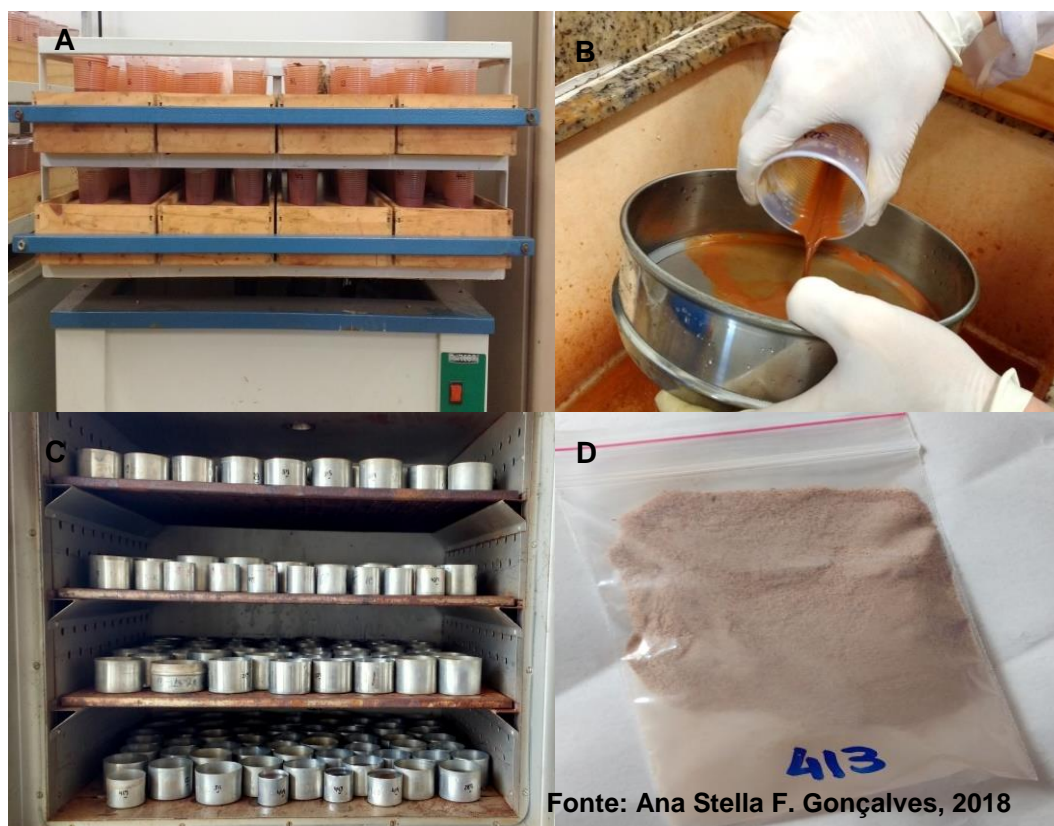
Figura 4 - Detalhes do procedimento para fracionamento físico da matéria orgânica do solo. A: Agitação das amostras em agitador horizontal. B: Separação das frações, em peneira de malha de 0,053 mm. C: Secagem em estufa a 50°C, em potes de alumínio, da fração particulada retida. D: Fração retida após moagem, para leitura em analisador elementar automático
