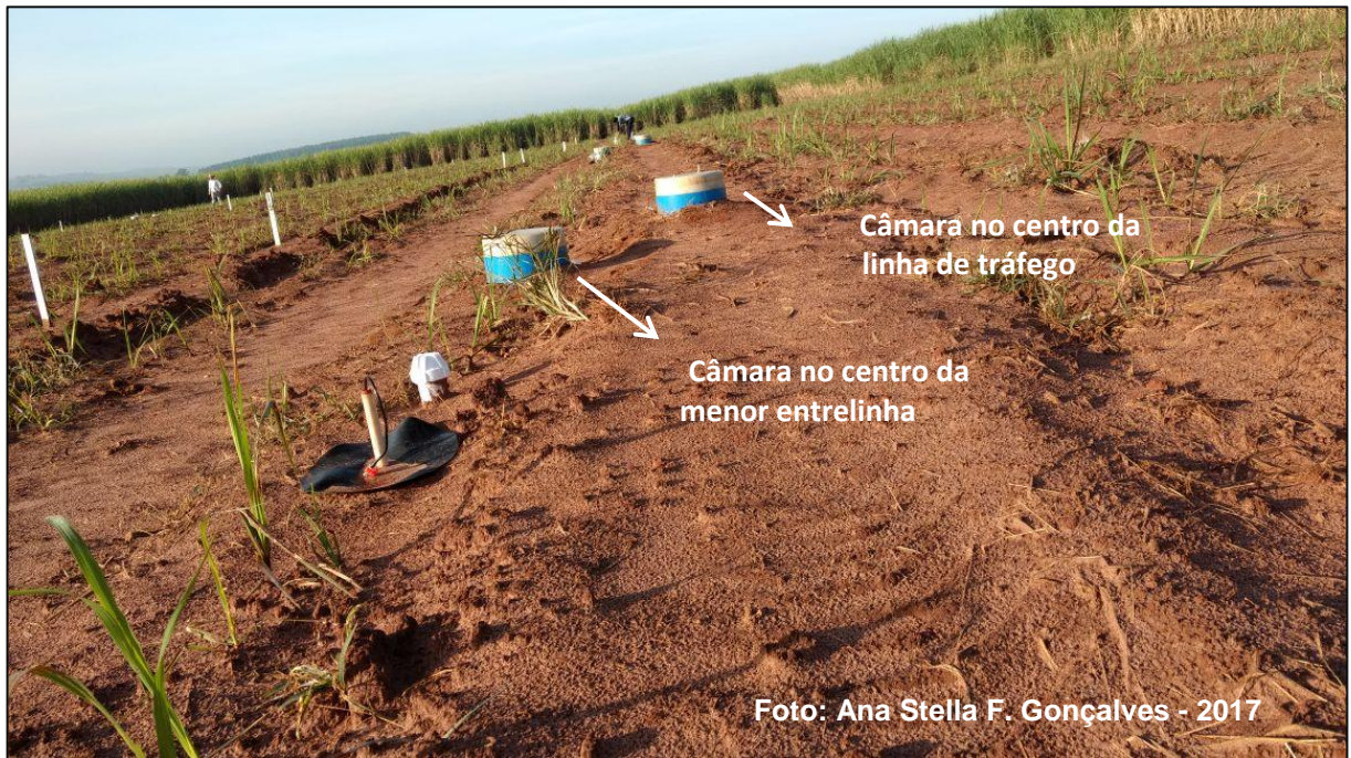
Figura 2 - Posicionamento das câmaras em cada parcela para avaliação das emissões de gases de efeito estufa, Lençóis Paulista - SP, 2017
