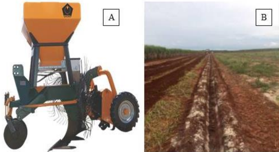
Figura 3 - Representação do equipamento “Penta”, com a presença de haste subsoladora e enxada rotativa, para realização do preparo profundo (A), com a respectiva aplicação de calcário apenas na faixa de plantio (B)
