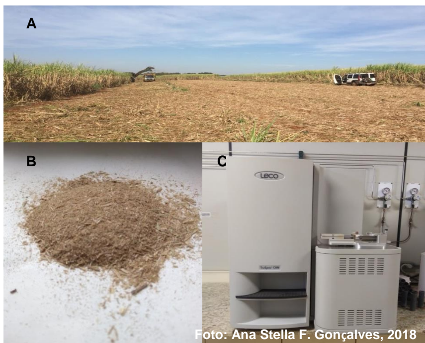
Figura 7 - Detalhes do procedimento para determinação do carbono residual em pós-colheita. A: Área em pós-colheita onde foram coletadas as amostras. B: Amostra após moagem em moinho elétrico tipo “Willey” com malha de 1 mm. C: Analisador elementar automático (Modelo TruSpec™ CHNS)
