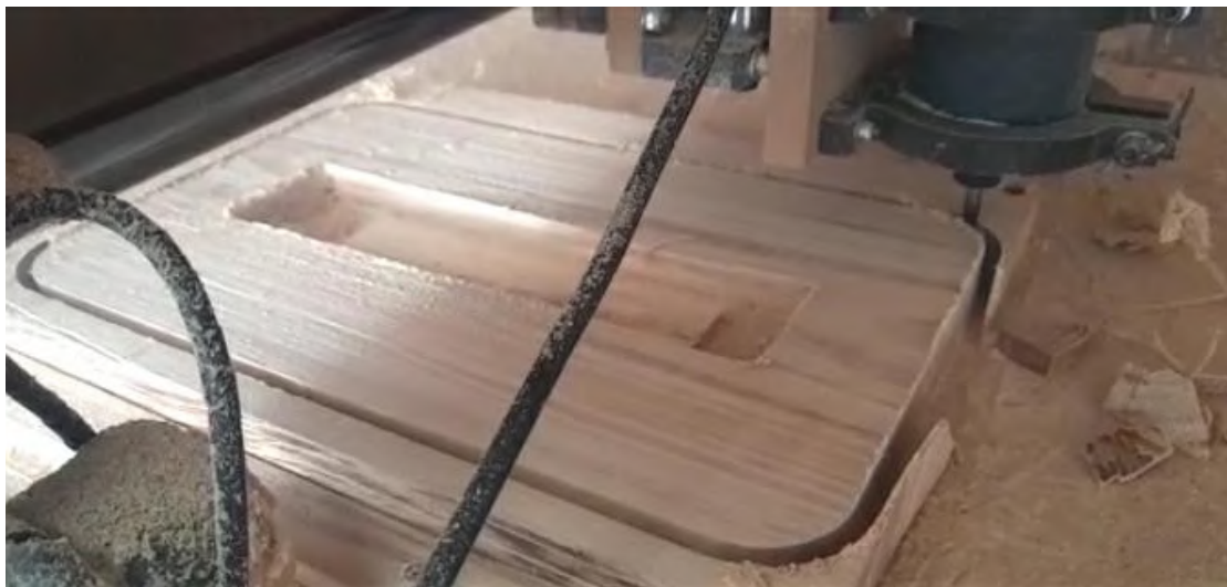
Imagem 43 - Processo de usinagem da peça base
